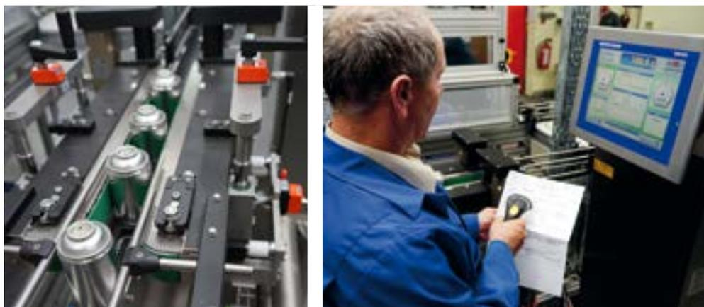
Una cadena en lugar de una cinta transportadora convencional, junto con el uso de transportadores con mordaza lateral, garantiza un transporte perfecto de los productos (imagen de la izquierda). Los parámetros de los productos almacenados en la base de datos se cargan en la controladora de peso al escanear un código de barras (imagen de la derecha).
