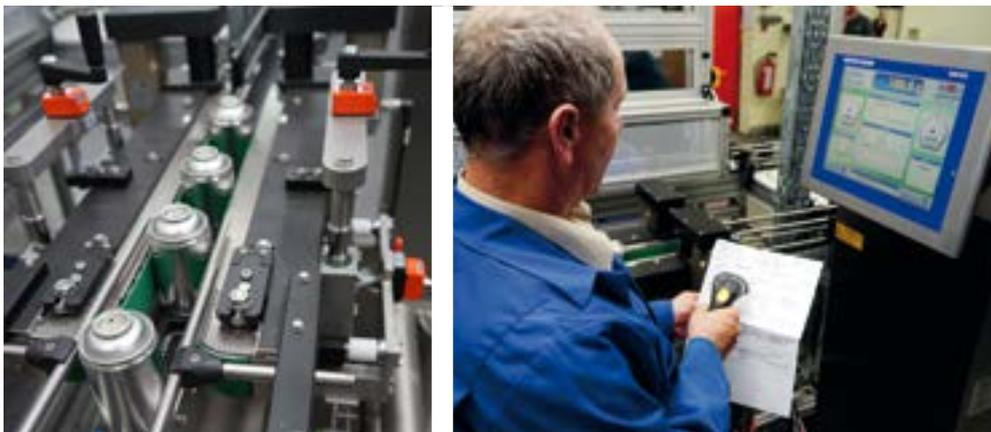
Anstelle eines herkömmlichen Förderbandes mit Side-Grip-Transportbändern wird der ruckfreie Produkttransport durch eine Kette gewährleistet (links). Durch Scannen eines Barcodes werden Produktparameter von der Datenbank an den Checkweiger übertragen (rechts).
