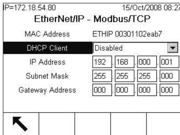
**Figure 3-142: Modbus TCP PLC Interface Setup Screen**
