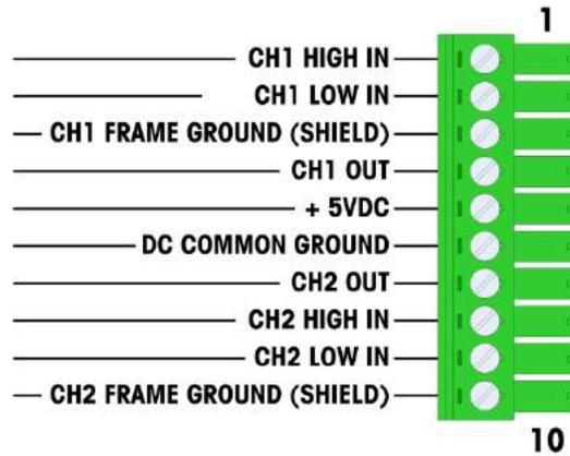
**Figure A-76: Flow Meter Connector**
