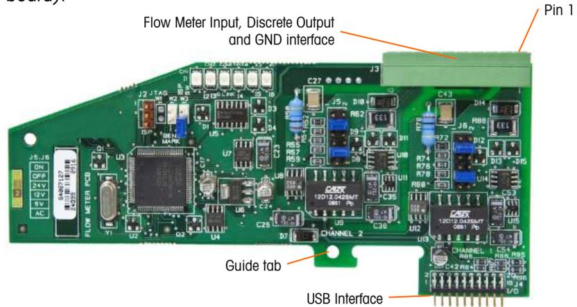
**Figure A-75: Flow Meter Option Board**
