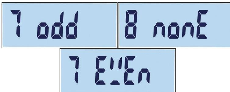
**Figura 3-66: Schermate per bit dati e bit di parità**
