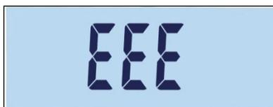
**Figura 3-21: Avvertenza acquisizione zero OIML**
