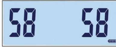
**Figura 3-71: Schermata di test della comunicazione seriale COM1**
