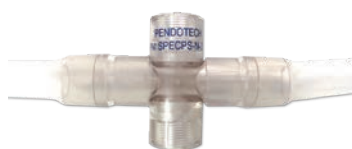
Célula de Fluxo Instalada com Tubulação
