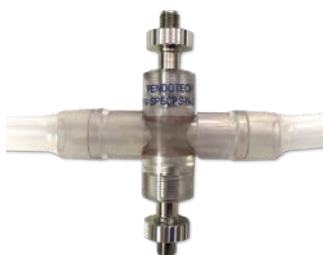
Acopladores Ópticos Instalados na Célula de Fluxo
