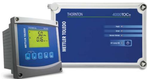
機能を高めた4000TOCeセンサは、メンテナンスの必要性が低い工業向けパッケージとして、全有機炭素の継続的オンライン測定を提供します。TOC濃度を測定するため、実証済みのUV酸化と差分導電率の使用に加えて、4000TOCeモデルには、自動流量制御も装備され、システムを通じた一貫性のある流量を確保します。
