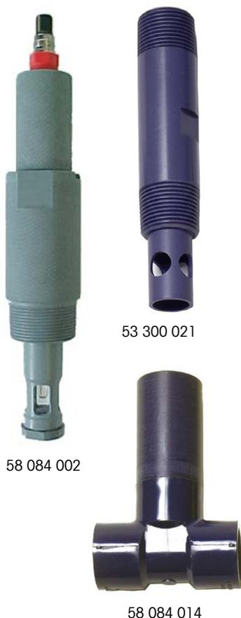
メトラー・トレド・ソーントンのハウジングは、固定式NPTまたは溶接接続タイプがあります。電極の洗浄、校正、交換を簡単にするために、内部にはOリングシールと取り付けナットが備わっています。メトラー・トレドの電極には、1本の電極に、測定機能、比較電極機能、迅速な反応の温度補正機能が搭載されています。
