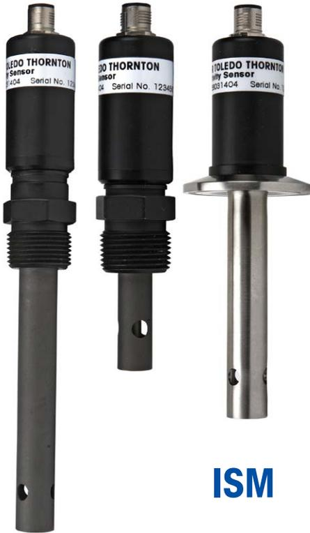
UniCond導電率/比抵抗センサは、高度な内蔵回路測定により、非常に広い測定範囲で高い精度の測定を提供します。オンボードの測定回路は、ケーブルの抵抗やキャパシタンスによる干渉を除去し、デジタル信号だけが変換器へ送信されます。ISMは、迅速で規制に準拠したシステムの立ち上げを実現する事前校正と「プラグ&メジャー」機能を備えています。
