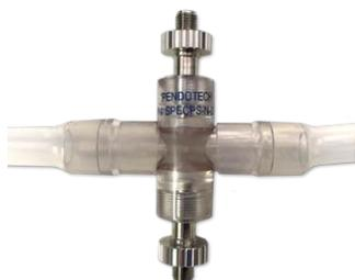
光ケーブルをフローセルに取り付け
