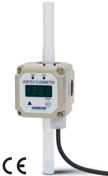
超純水や化学薬品の流量測定に究極のソリューションを提供。渦式流量センサは、PFA、PVC、PVDF製の成型ボディで構成されています。可動部がなく、耐腐食性の完全プラスチック構造のため、液体汚染の可能性を一切排除しています。
