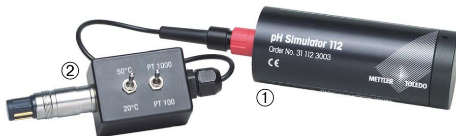
pHアナログ検証キット: pHシミュレータ112 ①と、VPシミュレータ②を組み合わせることで、pHと温度の信号を模して、変換器の自動温度補正機能をチェックします。
