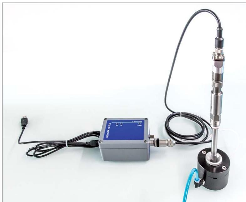
**iLink Multi**は、デジタルISMセンサ (1-wire、RS 485) をISM Coreソフトウェアを実行中のPC/ノートパソコンに接続するための汎用デバイスです。iLink Multiで光学式DOセンサを校正するときは、内蔵型の物理的パラメータセンサを使用して、校正パラメータを自動的にキャプチャします。
