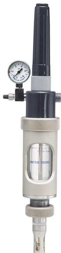
InFit 764 eハウジングは、電解液補充型pHおよびRedox電極の性能と寿命を最大化することを目的に設計されています。ハウジングのボディは、充填電解液とプロセス間の正の圧力偏差を保つために加圧できます。正の偏差により、プロセスが隔膜を超えてセンサに流入されることがなくなり、センサの汚染を防ぎます。大型のモニターウィンドウにより、電解液レベルを簡単にモニターできます。
