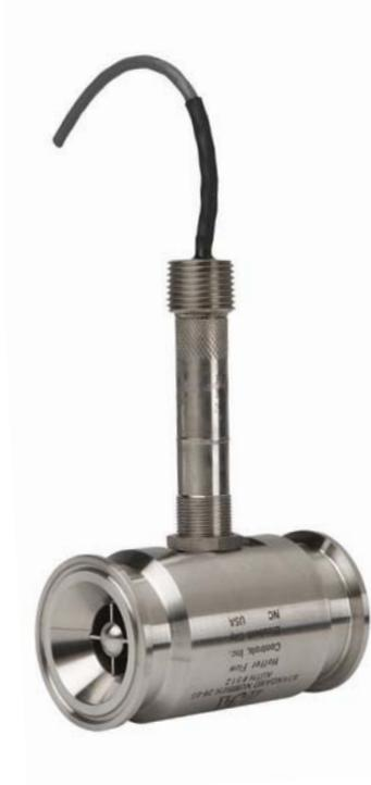
サニタリータービン流量計は ASME バイオプロセス機器規格 BPE-2014 に準拠するように設計および製造されており、高いサニタリー基準が要求されるプロセス液体の測定に適しています。ASME-BPE-2014 は、バイオ医薬品の製造に使用される機器の設計と製造方法に関する主要規格です。このシリーズには、0.75 ~ 400 GPM の流量に対応している Tri-Clamp™ の標準継手付きの 1/4" ~ 3" の 11 サイズがあります。
