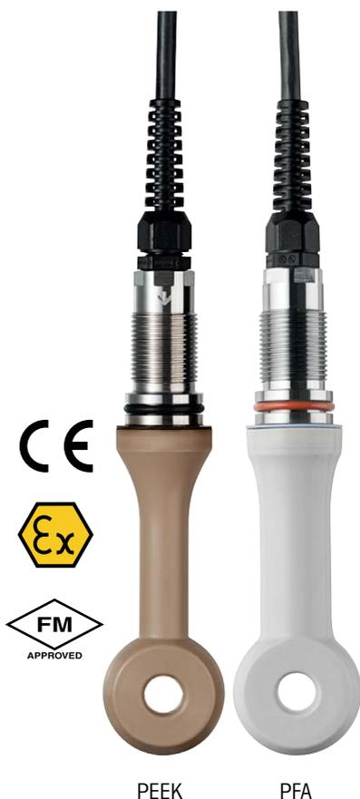
InPro 7250シリーズ導電率センサは、腐食性の化学薬品溶剤のプロセスや汚染水用途のために設計されています。これらの「無電極」センサには、サンプルと接触する電極がなく、従来の接触導電率センサのように、汚染の原因となる塗膜による影響を受けません。中度から非常に高い導電率レベルまで測定することができ、工業排水の測定および工業プロセスでの酸、塩基、塩の導電率/濃度レベルの測定などに最適です。
