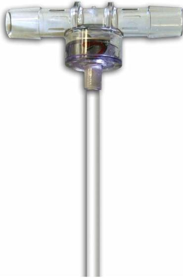
シングルユース圧力センサは、プロセスにおける気体や液体の静的および動的圧力を正確かつコスト効率良く測定します。ろ過およびクロマトグラフィープロセス、ガスおよびシングルユースバイオリアクターのモニタリング、充填操作などに最適です。内部には高精度圧力 (MEMS-HAP) チップが搭載されています。センサは一体型コネクタを介してモニターに接続します。適切な変換器には、PressureMATモニター/変換器、プロセス制御システム、またはその他の認定済みサードパーティ製モニターが含まれます。ペンドテックのPressureCheckerを使用して非侵襲的に現場でテストできます。市販されている既存のステンレス製圧力トランスデューサに代わる、配管用に使用する費用対効果の高いソリューションです。
