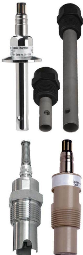
メトラー・トレド・ソーントンには、NPTまたはサニタリー継手付きアナログ導電率/比抵抗センサを、用途に合わせてさまざまな挿入長、セル定数、材質で提供しています。純水用チタン電極センサ、HFを含んだ洗浄水用モネル電極センサ、医薬用水用に高度に研磨された316Lステンレススチール(SS)電極センサ、高導電率溶液および/または浮遊物質用の4極式CPVCおよびPEEKセンサ、濃度も測定できるエポキシセンサなどの選択が可能です。
