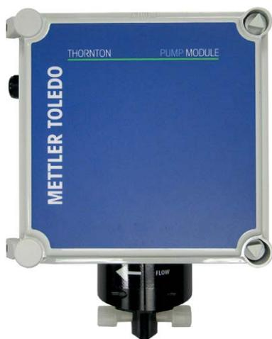
このポンプモジュールは高精度の容積式(PD)ポンプを使用しており、TOCセンサへ送液される水の流量は非常に安定します。そのため、信頼性が高く一貫性のあるTOC測定を行うことが可能となります。このアクセサリは、システム圧力が低くTOCセンサに十分な流量を提供できない場合や、運転中定期的にシステム圧力が変動し、低圧となってしまう場合に適しています。ポンプモジュールは、蒸留装置、RO透過液、CIPおよび医薬品プロセスの洗浄などの用途に最適です。
