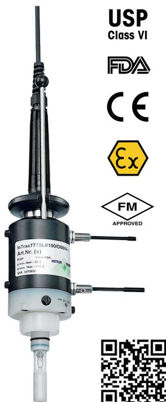
InTrac 777 e/779 e着脱式ハウジングは、pH、ORP、溶存酸素、CO<sub>2</sub>、導電率、濁度 (InTrac 779 e) の測定に 12 mm センサを利用するプロセスのアプリケーション向けに特別設計されています。このハウジングにはフラッシングチャンバーがあり、必要に応じて電極の洗浄や校正を、どちらもプロセスを中断することなく行うことができます。このハウジングは、過酷なアプリケーションにおいてもプロセスの安全性と信頼性を高める Tri-Lock セーフティシステムを搭載しています。InTrac 777 e/779 e は、様々なプロセス接続と構造の材質により、化学、バイオ医薬品、食品・飲料業界での使用に最適です。
