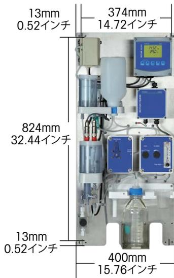
メトラー・トレドの2301Naナトリウム分析装置は、純水処理プロジェクト向けにオープンパネルマウント設計を採用しています。最低測定限界が0.01ppbの分析装置は、トレース測定アプリケーションに適しています。手動校正プロセスを備え、低メンテナンスの分析装置は、正確な測定を確保し、純水処理時のカチオン樹脂の破過の特定に役立ちます。この分析装置には、お客様のプロジェクトのニーズに応じて機能を強化することができるアドオン機能があります。
