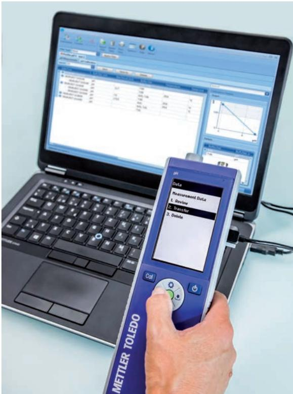
Trasferimento dati tramite interfaccia USB.
