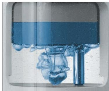
Azione pulente dell'EasyClean 100. La formazione di bolle centrate al di sotto del sensore garantisce una pulizia delicata.
