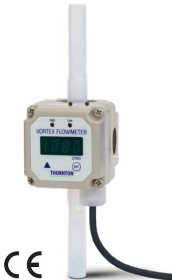
La soluzione definitiva per misurare le portate di acqua ultrapura e sostanze chimiche. I sensori di flusso a vortice sono costituiti da un unico corpo stampato e sono disponibili in PFA, PVC o PVDF. Senza parti in movimento, eventuali rischi di contaminazione dei fluidi vengono eliminati dalla costruzione interamente in plastica resistente alla corrosione.
