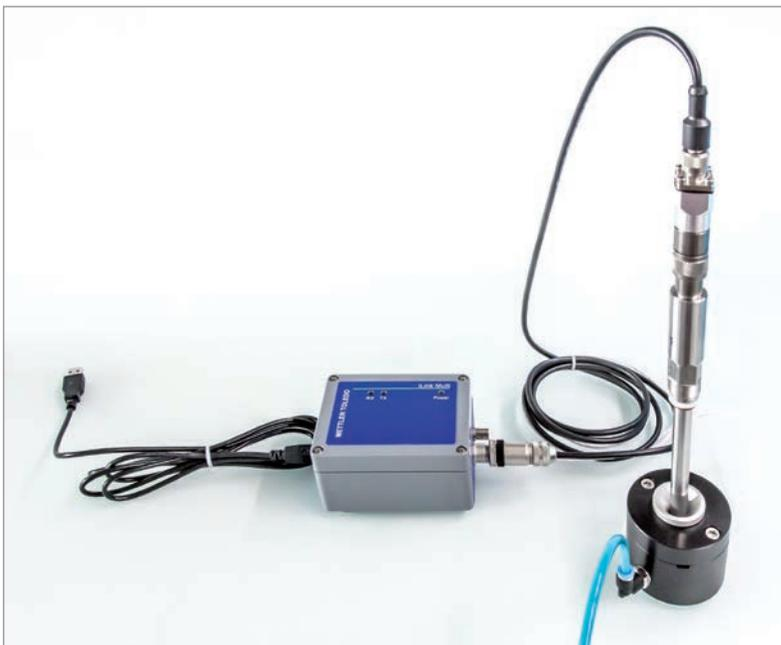
**iLink Multi** è un dispositivo universale per il collegamento di sensori ISM digitali (a 1 filo; RS 485) a PC/laptop che utilizzano il software ISM Core. Durante la taratura di un sensore ottico di OD con iLink Multi, i parametri di taratura vengono raccolti automaticamente utilizzando dei sensori di parametri fisici integrati.
