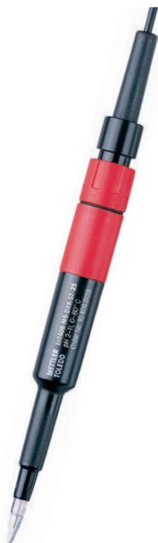
I sensori pH a penetrazione sono appositamente studiati per misurare il pH in modo rapido ed accurato in carni, salsicce, formaggio e frutta. La robusta membrana di rilevamento a punta penetra direttamente nel fluido, senza richiedere una lunga preparazione del campione. Il sistema di riferimento polimerico solido elimina gli intasamenti da grassi e proteine usando una giunzione aperta. L'elettrolita di riferimento non ricaricabile riduce al minimo la manutenzione.
