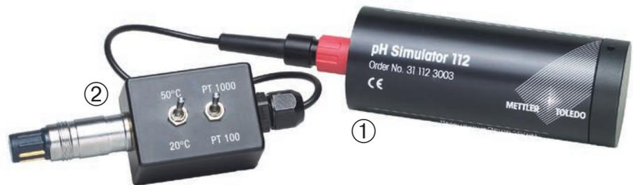
Kit analogici di verifica pH: Combinando il simulatore di pH 112 ① con il simulatore VP ②, sia i segnali di pH sia quelli della temperatura possono essere simulati per verificare la capacità di compensazione automatica della temperatura del trasmettitore.
