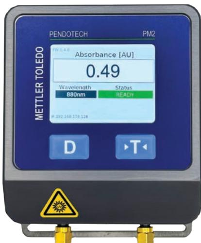
Il fotometro PM2 è uno strumento versatile per applicazioni di laboratorio e di processo, disponibile in versioni da banco e da pannello per una facile integrazione in vari sistemi. Viene fornito con sette combinazioni di lunghezze d'onda configurabili in fabbrica, tra cui 260 nm, 280 nm, 300 nm, 880 nm, 260 -280 nm, 280 -300 nm e 280 - 880 nm.
