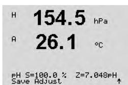
Assim que os critérios de estabilização forem cumpridos, o display muda para mostrar o fator “S” de calibração de declive e o fator “Z” de calibração de deslocamento.
