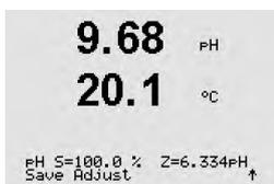
Após a calibração, são exibidos o fator de calibração de declive "S" e o fator de calibração de deslocamento "Z".
