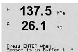
Coloque o eletrodo na primeira solução de buffer e pressione a tecla [ENTER] para começar a calibração.
