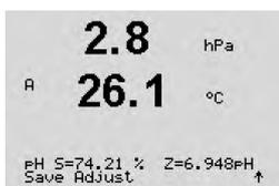
Assim que os critérios de estabilização forem cumpridos, a tela muda para mostrar o fator "S" de calibração de declive e o fator "Z" de calibração de deslocamento.
