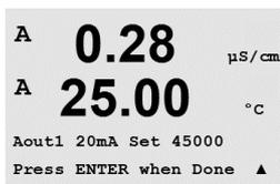
Conecte um medidor de miliamperes preciso aos terminais de saída analógica e ajuste o número de cinco dígitos no display até o medidor de miliamperes mostrar uma leitura de 4,00 mA e repita para 20,00 mA.
