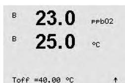
Dependendo da temperatura medida do meio, o LED do sensor pode ser desligado automaticamente. Se a temperatura da mídia for maior que Toff o LED será desligado. O LED será ligado assim que a temperatura da mídia cair abaixo de Toff - 3K. Esta função permite aumentar a vida útil do OptoCap ao desligar o LED nos ciclos SIP ou CIP.
