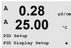
Quando PID display for selecionado, o status (Man ou Automático) e a saída de controle (%) serão exibidos na linha inferior. Se estiver controlando o pH, o reagente também será exibido. Além disso, para o display ser ativado, uma medição deve ser atribuída em Ajustar parâmetros e um OC ou uma saída analógica deve ser designada em Modo.
