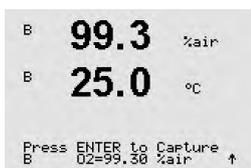
Tome uma amostra e pressione novamente a tecla [ENTER] para armazenar o valor de medição atual. Para mostrar o processo de calibração em andamento, A ou B (dependendo do canal) permanece cintilando no display.
