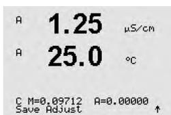
Após a calibração o multiplicador de células ou fator de calibração de inclinação "M", ou seja, são exibidos a constante de célula e o Adicionador ou fator de calibração de deslocamento "A".
