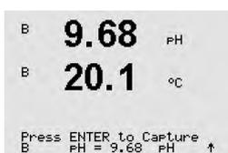
Colha uma amostra e pressione a tecla [ENTER] novamente para armazenar o valor da medição atual. Para mostrar o processo de calibração em andamento, A ou B (dependendo do canal) permanece cintilando no display.
