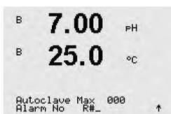
O limite do processo de autoclave conta o número de processos de autoclave. Se o limite (definido pelo usuário) for atingido, um alarme pode ser indicado e definido para um OC de saída determinado. As seguintes opções são possíveis:
