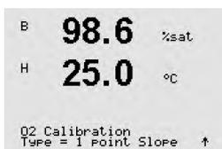
Selecione 1 ponto seguido por Slope ou ZeroPt como o tipo de calibração. Pressione [ENTER].
