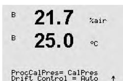
Para o algoritmo de calibragem do processo, a pressão aplicada (ProcCalPres) deverá ser definida. Tanto o valor da pressão do processo (PresProc) como a pressão de calibração (PresCal) pode ser utilizada. Escolhida a pressão aplicável durante a calibragem do processo, esta deverá ser utilizada no algoritmo.
