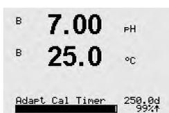
**Temporizador Adaptativo de Calibração:** Esse temporizador mostra um Temporizador Adaptativo de Calibração quando a próxima calibração deve ser realizada, para manter o melhor desempenho de medição possível. O Temporizador Adaptativo de Calibração é indicado em dias (d) e em porcentagem (%). Para obter uma descrição do Temporizador Adaptativo de Calibração, consulte a seção 8.6 "Configuração ISM".
