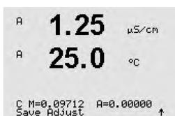
Após a calibração do multiplicador de células ou fator de calibração de inclinação "M", ou seja, são exibidos a constante de célula e o Somador ou fator de calibração de deslocamento "A".
