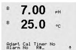
Ativação do **Temporizador Adaptativo de Calibração:** Esse temporizador estima quando a próxima calibração deverá ser realizada para manter o melhor desempenho de medição possível. O temporizador é influenciado por alterações significativas nos parâmetros DLI.
