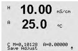
Após a calibração o Multiplicador ou fator de calibração de slope “M” e o Somador ou fator de calibração de deslocamento “A” são exibidos.
