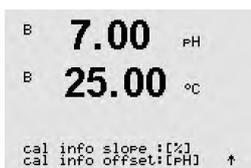
Podem ser escolhidas as unidades do declive e ponto zero que serão mostradas no display. A configuração padrão da unidade do declive é [%] e pode ser mudada para [pH/mV]. Para o ponto zero a configuração padrão da unidade é [pH] e pode ser mudada para [mV]. Use a tecla ► para ir até o campo de entrada e selecionar a unidade usando a tecla ▲ ou ▼.
