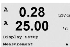
Selecione o modo "Exibir erro". Se estiver definido para "Ligado" quando um alarme ou advertência ocorrer, será exibida a mensagem "Falha – Aperte Enter" na linha 4 quando ocorrer um alarme no modo de medição normal.
