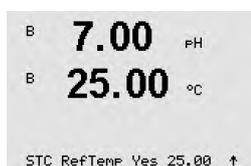
**STC RefTemp** define a temperatura à qual a compensação de temperatura da solução é referenciada. O valor exibido e o sinal de saída são referenciados a STC RefTemp. Selecionar “Não” significa que a compensação de temperatura da solução não é usada. A temperatura de referência mais comum é 25 °C. Pressione [ENTER].
