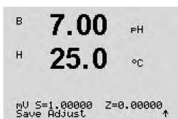
O display mostra o fator de calibração de declive “S” e o fator de calibração de deslocamento “Z”.
