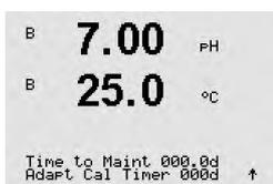
O valor inicial do Tempo para Manutenção e também do Temporizador Adaptativo de Calibração pode ser modificado de acordo com a experiência de aplicação e o carregado no sensor.
