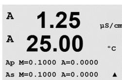
Todas as constantes de Calibração do canal de sensor selecionado são exibidas. As constantes de medição primária (p) são exibidas na Linha 3. As constantes de medição secundária (temperatura) (s) do sensor são exibidas na Linha 4.
