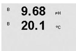
Após determinar o valor de pH da amostra, pressione a tecla [CAL] novamente para continuar a calibração.
