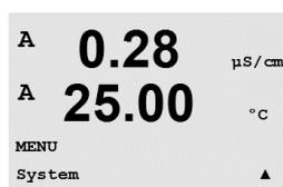
測定モード中に、◀ キーを押します。▼ キーまたは ▲ キーを押して、[システム]メニューに進み、[ENTER]を押します。
