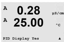
PIDディスプレイを選択すると、状態 (手動または自動) とコントロール出力 (%) が一番下の列に表示されます。pHをコントロールすると試薬も表示されます。さらにディスプレイを有効にするには、[チョウセイパラメータ]で測定を割り当て、オープンコレクター(OC)またはアナログ出力をモードで割り当てる必要があります。
