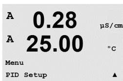
測定モード中に、◀ キーを押します。▲ または ▼ キーを押して、[PIDセッテイ]メニューに進み、[ENTER]を押します。
