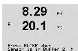
安定基準が満たされるとディスプレイ上に2番目の標準液に電極を浸すように指示が出されます。
