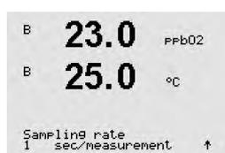
センサのある測定サイクルから別の測定サイクルまでの間隔を調整することができます。つまり、用途に適応させることが可能です。値が大きいと、センサのOptoCapの寿命が増加します。
