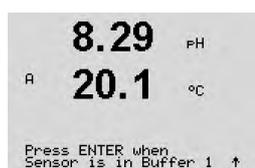
最初の標準液に電極を浸して[ENTER]キーを押します。
