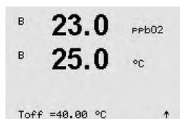
測定媒体温度により、センサのLEDは自動的にオフになります。媒体温度がToffよりも高い場合、LEDはオフになります。媒体温度がToff - 3Kよりも低くなると、LEDはオンになります。この機能により、SIPまたはCIPサイクルを通じてLEDをオフにすることにより、OptoCapの寿命を増加させることが可能になります。
