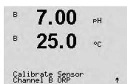
7.1章「校正モードを入力します」で示したようにORP校正モードを選択します。
