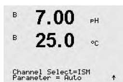
センサの種類としてISMを選択して[ENTER]を押します。
