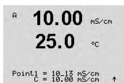
サンプルの導電率の値を入力し、[ENTER]キーを押して校正結果の計算を開始します。
