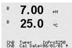
センサに関する以下の情報がこのメニューに表示されます。上下の矢印のキーでメニューをスクロールします。タイプ: センサのタイプ (例InPro 3250)
