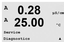
このメニューは、トラブルシューティングのための自己診断機能で、下記にあげる機能を提供します。モデル/ソフトウェアリビジョン、デジタル入力、ディスプレイ、キーパッド、メモリ、オープンコレクター (OC) の設定、読み込み、アナログアウトブットセットイ、アナログシュツリョクヨミコミ。
