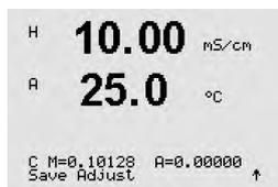
校正後には、マルチプライヤまたはスロープ校正ファクタの"M"とAdderまたはオフセット校正ファクタの"A"が表示されます。
