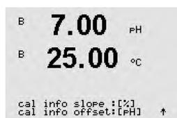
スロープとゼロ点用の単位は、ディスプレイ上に表示されたものを選択することができます。スロープの単位の初期設定は[%]であり、[pH/mV]に変更することができます。ゼロ点においては、単位の初期設定は[pH]であり、[mV]に変更することができます。▶ キーを使用して入力フィールドに移動し、▲ または▼ キーを使用して装置を選択します。
