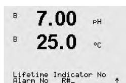
**ライフタイムヒョウジ:** アンペロメトリックO<sub>2</sub>センサのインテリアボディ、pH電極の寿命が終わりに近づくと、実際にさらされている負荷を考慮して、大まかな寿命の目安を推測することができます。センサは、過去の平均的な負荷を考慮します。またそれにしたがって、寿命を伸ばしたり縮めたりすることができます。
