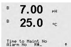
**メンテナンスマデ:** このタイマは、最適な測定を実施し続けるために次のセンサの洗浄時期を推定します。タイマにはDLIパラメータの大きな変化が影響します。
