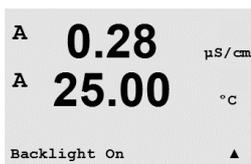
使用できる設定は、On、On 50%、または[オートOff 50%]です。[オートOff 50%]を選択すると、4分間キーパッドに触れないと、バックライトは50%になります。キーを押すとバックライトは自動的に回復します。
