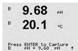
サンプルを取得し、[ENTER]キーをもう一度押して、現在の測定値を保存します校正中の場合、チャンネルに応じてAまたはBがディスプレイで点滅します。
