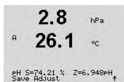
ディスプレイに、スロープ校正ファクタのSとオフセット校正ファクタのZが表示されます。
