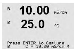
校正中の場合、校正で使用されているチャンネルを示す"A"または"B"がディスプレイ上で点滅します。
