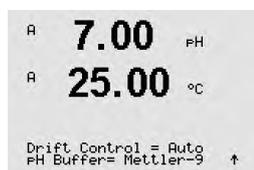
**ドリフトコントロール**で[ジドウ] (ドリフトと基準時間を満たしている必要あり) または手動 (信号が十分に安定して校正を完了できるタイミングをユーザーが決定可能) を選択してから、自動標準液認識に対応する標準液規格を選択します。ドリフト率が、19秒間に0.4 mV以下の場合、測定値は安定し最新の測定値を使用して、校正を完了します。300秒以内に基準のドリフトに達しない場合、校正は時間切れになり、[コウセイムコウ]。[ENTERヲオシテシユウリョウ]というメッセージが表示されます。
