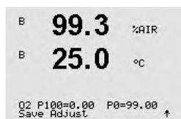
安定化基準が満たされると、ディスプレイ表示が変化します。ディスプレイには、100% (P100) および0% (P0) の空気におけるセンサの位相の値を示しています。
