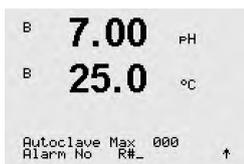
[オートクレープサイクルリミット]はオートクレープサイクルの数をカウントします。(ユーザー定義の)限度に達した場合、アラームを表示し、オープンコレクター (OC) の出力を設定することができます。次のオプションが利用できます。
