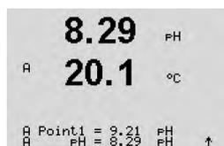
電極を1番目の標準液に浸します。ディスプレイには、変換器によって識別された標準液 [ポイント1]と測定した値が表示されます。[ENTER]を押して続行します。
