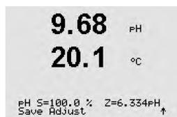
校正後に、スロープ校正ファクタSとオフセット校正ファクタZが表示されます。
