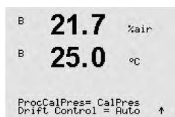
プロセス校正のアルゴリズムについては、適用される圧力(ProcCalPres)が定義される必要があります。プロセス圧力(プロセスアツリョク)または校正圧力(CalPres)の値を使用することができます。プロセス校正中に適用される圧力またはアルゴリズムに使用するべき圧力を選択します。
