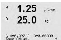
セルマルチプライヤまたはスロープ校正ファクタの“M”(セル定数など)の校正後は、Adderあるいはオフセット校正ファクタの“A”が表示されます。
