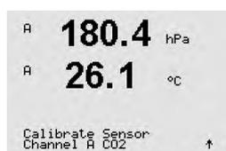
[1テン]校正を選択します。CO<sub>2</sub>センサーにより、1点校正が常にオフセット校正として実施されます。
