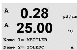
◀と▶キーを使用して、変更する数字間を移動します。▲および▼キーを使用して、表示する文字を変更します。ディスプレイにある両方のチャンネルのすべての数字を入力したら、[ENTER]を押して[ヘンコウヲホゾン]ダイアログを表示します。
