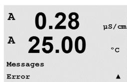
最新のメッセージが表示されます。上下の矢印キーを使用して、最後から4つの発生したメッセージにスクロールできます。
