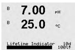
ライフタイムヒョウジ: 信頼できる測定を行うために使用期間の推定残り時間を示します。寿命は日数 (日) とパーセンテージ (%) で示されます。ライフタイムヒョウジの詳細については、8.6章の「ISMセットアップ」を参照してください。O<sub>2</sub>センサでは、ライフタイムヒョウジはセンサのインテリアボディの寿命を表しています。画面にスライド式のインジケータを表示したい場合は、8.7.5章「ISMセンサモニタリング」の説明に従ってISM機能を有効にしてください。
