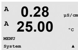
No modo de medição, pressione a tecla ◀. Pressione a tecla ▼ ou ▲ para navegar até “Sistema” – Menu e pressione [ENTER].
