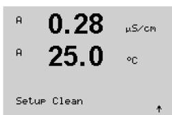
O intervalo de limpeza pode ser definido entre 0,000 e 999,9 horas. Configurar para 0 desativa o ciclo de limpeza. O tempo de limpeza pode ser 0 a 9999 segundos e deve ser menor do que o intervalo de limpeza.
