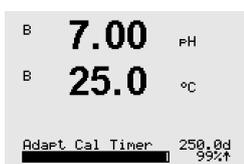
Temporizador de Cal adaptativo: Esse temporizador mostra um Temporizador de Cal adaptativo quando a próxima calibração deve ser realizada, para manter o melhor desempenho de medição possível. O Temporizador de Cal adaptativo é indicado em dias (d) e em porcentagem (%). Para obter uma descrição do Temporizador de Cal adaptativo, consulte a seção 8.4 "Configuração ISM (disponível para Sensores ISM de pH, oxigênio e dióxido de carbono dissolvido)".
