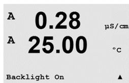
As configurações possíveis são Ligado, Ligado 50% ou Desligado Automático 50%. Se Desligado Automático 50% for selecionado, a luz de fundo diminuirá para 50% após 4 minutos se não houver atividade no teclado. A luz de fundo voltará automaticamente se uma tecla for pressionada.
