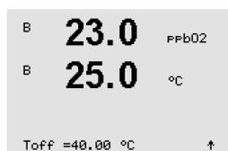
Dependendo da temperatura medida da mídia o LED do sensor pode ser desligado automaticamente. Se a temperatura da mídia for maior que Toff o LED será desligado. O LED será ligado assim que a temperatura da mídia cair abaixo de Toff - 3K. Esta função permite aumentar a vida útil do OptoCap ao desligar o LED nos ciclos SIP ou CIP.
