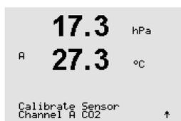
Selecione Calibração de processo. Com sensores de CO<sub>2</sub> uma calibração de processo é sempre executada como uma calibração de compensação.
