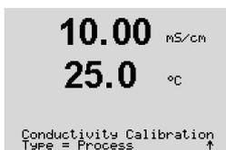
Selecione "Calibração de Processo" e pressione [ENTER]. Com sensores de condutividade a calibração de processo é sempre executada como uma calibração de "Slope".
