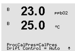
Para o algoritmo de calibração do processo, a pressão aplicada (ProcCalPres) deverá ser definida. Tanto o valor da pressão do processo (PresProc) como a pressão de calibração (PresCal) pode ser utilizada. Escolhida a pressão aplicável durante a calibração do processo, esta deverá ser utilizada no algoritmo.
