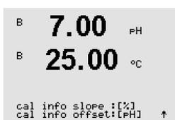
Podem ser escolhidas as unidades do declive e ponto zero que serão mostradas no display. A configuração padrão da unidade do declive é [%] e pode ser mudada para [pH/mV]. Para o ponto zero a configuração padrão da unidade é [pH] e pode ser mudada para [mV]. Use a tecla ► para ir até o campo de entrada e selecionar a unidade usando a tecla ▲ ou ▼.
