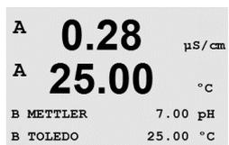
O display resultante no modo de medição aparece nas linhas 3 e 4 à frente das medições.
