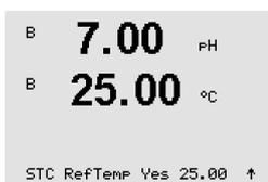
**STC RefTemp** define a temperatura à qual a compensação de temperatura da solução é referenciada. O valor exibido e o sinal de saída são referenciados a STC RefTemp. Selecionar Não significa que a compensação da temperatura da solução não é usada. A temperatura de referência mais comum é 25 °C. Pressione [ENTER].
