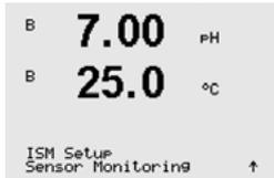
센서 모니터링 옵션은 켜거나 끌 수 있습니다. FF 인터페이스를 통해 이산 입력 블록에 의해 제공되는 센서 모니터링 값을 읽을 수 있습니다. 다음 옵션이 가능합니다.
