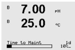
**Time to Maintenance:** 이 타이머는 최상의 측정 성능을 유지하기 위해 다음 세척 사이클을 수행해야 할 시기인 유지 보수 시기를 보여줍니다. 유지 보수 시기는 일수(d) 및 비율(%)로 표시됩니다. 유지 보수 시기에 대한 설명은 섹션 8.4 "ISM 설정(pH, 산소 및 용존 이산화탄소 ISM 센서에 사용 가능)"을 참조하십시오. 산소 센서의 경우 유지 보수 시기는 멤브레인과의 전극의 유지 보수 사이클을 나타냅니다.
