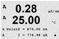
Point 2를 입력한 후 [ENTER] 키를 누르면 확인 화면이 나옵니다. Yes를 선택하여 고정 값을 저장하면 디스플레이에 Successful Calibration이 확인됩니다. 트랜스미터는 약 5초 후 측정 모드로 돌아갑니다.
