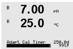
**Adaptive Cal Timer:** 이 타이머는 최상의 측정 성능을 유지하기 위해 다음 교정을 수행해야 할 시기인 적응형 교정 타이머를 보여줍니다. 적응형 교정 타이머는 일수(d) 및 비율(%)로 표시됩니다. 적응형 교정 타이머에 대한 설명은 섹션 8.4 "ISM 설정(pH, 산소 및 용존 이산화탄소 ISM 센서에 사용 가능)"을 참조하십시오.
