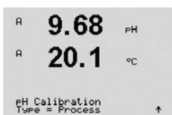
Process Calibration을 선택합니다. pH 센서를 사용한 공정 교정은 항상 오프셋 교정으로 수행됩니다.
