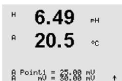
이제 사용자는 Point 1에 들어갈 수 있습니다. 오프셋 교정 계수는 측정값(line 4, mV = ...) 대신 Point1 값을 이용하여 계산되고 다음 화면에 표시됩니다.
