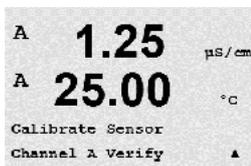
전기 단위로 된 일차와 이차 측정의 측정된 신호가 표시됩니다. 이 값을 교정할 때 미터 교정 요소가 사용됩니다.
