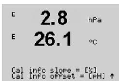
화면에 표시된 기울기의 단위와 영점을 선택할 수 있습니다. 기울기 단위에 대한 기본 설정은 [%]이고 [pH/mV]로 변경할 수 있습니다. 영점의 경우 단위의 기본 설정은 [pH]이고 [mV]로 변경할 수 있습니다. ▶ 키를 이용하여 입력 필드로 이동하고 ▲ 또는 ▼ 키를 이용하여 단위를 선택합니다.
