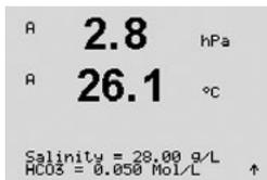
**염도**는 트랜스미터에 연결된 센서의 CO<sub>2</sub> 전해질 내에 있는 용존 소금의 총량을 설명합니다. 이것은 센서별 파라미터입니다. 기본값(28.00 g/L)은 InPro 5000에 유효합니다. InPro 5000을 사용할 경우 이 파라미터를 변경하지 마십시오.
