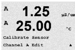
선택된 센서에 대한 모든 교정 상수가 표시됩니다. 주요한 측정 상수(p)는 Line 3에 표시됩니다. 센서에 대한 2차 측정(온도) 상수(s)는 Line 4에 표시됩니다.
