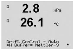
교정을 위해 **드리프트 제어**를 Auto(드리프트와 시간 기준을 준수해야 함) 또는 Manual(언제 신호가 교정을 완료할 만큼 충분히 안정되는지 사용자가 결정할 수 있음)로 선택한 다음 자동 버퍼 인식을 위한 관련 버퍼 테이블을 선택합니다. 드리프트율이 19초 간격 동안 0.4 mV 이하인 경우 판독값은 안정되고 마지막 판독을 이용하여 교정이 수행됩니다. 300초 내에 드리프트 기준이 충족되지 않으면 교정이 끝나고 “Calibration Not Done Press ENTER to Exit” 메시지가 표시됩니다.
