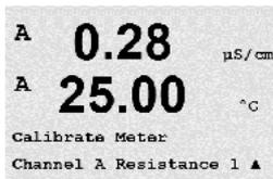
M400 트랜스미터는 규격 내로 공장에서 교정되어 출시됩니다. Calibration Verification에서 확인되는 대로 극한의 조건으로 규격을 크게 벗어난 조작이 발생되지 않는 이상 계측기를 다시 교정할 필요는 없습니다. Q.A 요건을 준수하기 위해 주기적인 확인/재교정은 필요할 수 있습니다. 계측기 교정은 Current(대부분의 용존산소의 경우 사용), Voltage, Rg Diagnostic, Rr Diagnostic(pH에 사용)과 Temperature(모든 측정에 사용)으로 선택할 수 있습니다.
