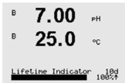
**Lifetime Indicator:** 신뢰성 있는 측정을 보장하기 위한 잔여 수명의 추정을 표시합니다. 수명은 일수(d) 및 비율(%)로 표시됩니다. 수명 표시기에 대한 설명은 섹션 8.4 "ISM 설정(pH, 산소 및 용존 이산화탄소 ISM 센서에 사용 가능)"을 참조하십시오. 산소 센서의 경우 수명 표시기는 센서의 내부 전극과 관련되어 있습니다. 화면에 막대 표시기를 불러오려면 8.7.5장 "ISM 모니터링"을 참조하여 ISM 기능을 활성화시킵니다.
