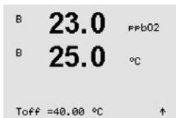
측정된 매질 온도에 따라 센서의 LED가 자동적으로 꺼질 수 있습니다. 매질 온도가 Toff 보다 높은 경우 LED가 꺼집니다. 매질 온도가 Toff - 3K 미만이 되는 즉시 LED가 켜지게 됩니다. 이 기능은 SIP 또는 CIP 사이클에 걸쳐 LED를 끄으로써 OptoCap의 수명을 높이는 옵션을 제공합니다.
