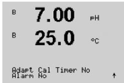
**Adaptive Cal Timer 활성화:** 이 타이머는 가능한 최고의 측정 성능을 유지하도록 다음 교정이 수행되어야 하는 시기를 추정합니다. 이 타이머는 DLI 파라미터의 중대한 변경에 의해 영향을 받습니다.
