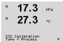
샘플을 취하고 [ENTER] 키를 다시 눌러 현재 측정값을 저장합니다. 진행 중인 교정 공정을 표시하기 위해 화면에 A 또는 B(채널에 따라)가 깜박입니다. 샘플의 CO<sub>2</sub> 값 결정 후 ▶ 키를 다시 눌러 교정을 진행합니다.
