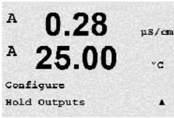
“Hold outputs” 기능은 교정 공정 동안 적용됩니다. “Hold outputs”을 Yes로 설정한 경우 교정 공정 동안 FF 인터페이스의 해당 아날로그 입력은 홀드 상태에 있습니다. 홀드 상태는 설정에 달려 있습니다. 가능한 홀드 설정에 대해서는 아래 표를 참조하십시오. 다음 옵션이 가능합니다.
