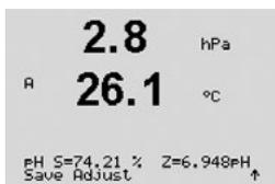
“Adjust” 또는 “Calibrate”이 선택된 경우 “Calibration successful” 메시지가 표시됩니다. 디스플레이에 “Re-install sensor”와 “Press Enter” 메시지가 표시됩니다. “ENTER”를 눌러 M400을 측정 모드로 돌리십시오.
