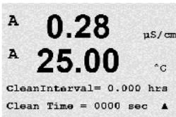
Cleaning 간격은 0.000 ~ 999.9 시간으로 설정할 수 있습니다. 0으로 설정하면 세척 사이클이 꺼집니다. 세척 시간은 0 ~ 9999초가 될 수 있고 Cleaning Interval보다 작아야 합니다.
