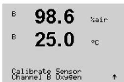
산소 센서의 1점 교정은 항상 1점 기울기(예, 공기로) 또는 영점(오프셋) 교정입니다. 1점 기울기 교정은 공기중에서 수행되고 1점 오프셋 교정은 0 ppb 산소에서 수행됩니다. 1점 zero 용존산소 교정도 이용 가능하지만 zero 산소는 달성하기 매우 어렵기 때문에 일반적으로 권장하지 않습니다. 영점 교정은 낮은 산소 농도(5%공기 이하)에서 높은 정확성이 요구될 때에만 시행할 것을 권장합니다.
