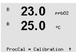
파라미터 **ProcCal**을 통해 공정 교정에 대하여 크기 조정과 교정 중에 선택합니다. 크기 조정이 선택된 경우 센서의 공정 곡선은 그대로이지만 센서의 출력 신호는 확대됩니다. 교정 값이 <1%인 경우 크기 조정 중 센서 출력 신호의 오프셋이 수정되며 값이 >1%인 경우 센서 출력의 기울기가 조정됩니다. 크기 조정에 대한 자세한 정보는 센서 매뉴얼을 참조하십시오.
