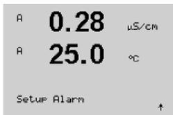
이 메뉴로 화면의 경보 기능을 구성할 수 있습니다. FF 인터페이스를 통해 이산 입력 블록에 의해 제공되는 경보 상태를 읽을 수 있습니다. 자세한 정보는 CD-ROM의 문서 “FOUNDATION fieldbus 파라미터 멀티 파라미터 트랜스미터 M400 FF”를 참조하십시오.
