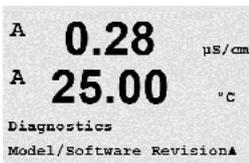
모든 서비스 전화에서 필수적인 정보는 모델과 소프트웨어 개정본 번호입니다. 이 메뉴는 트랜스미터의 시리얼 번호, 모델과 부품 번호를 보여줍니다. ▼ 키를 이용하여 이 메뉴를 더 탐색하고 트랜스미터에 구현된 펌웨어의 현재 버전 (Master V\_XXXX 및 Comm V\_XXXX) 그리고 ISM 센서가 연결된 경우 센서 펌웨어(센서 FW V\_XXX)와 센서 하드웨어(센서 HW XXXX)의 버전과 같은 추가 정보를 얻을 수 있습니다.
