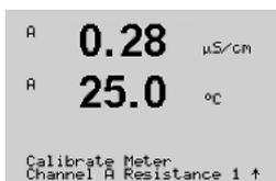
Calibrate Meter 화면으로 가서 Channel A 또는 B와 Resistance 1을 선택하여, 트랜스미터가 최초 범위 레지스터를 교정할 준비가 되었다고 명시합니다. 이 저항은 범위 1~ 5에서 선택하여 변경할 수 있습니다. 각 저항 범위는 2점 교정으로 구성됩니다.
