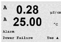
이러한 기준이 Yes로 설정되고 경보에 대한 조건이 제공되면 깜박이는 기호  $\Delta$  가 디스플레이에 표시되고 경보 메시지가 기록되고("메시지"장 참조, 경로: Info/Messages) FF 인터페이스를 통해 이산 입력 블록에 의해 제공되는 경보 상태를 읽을 수 있습니다. 자세한 정보는 CD-ROM의 문서 "FOUNDATION fieldbus 파라미터 멀티 파라미터 트랜스미터 M400 FF"를 참조하십시오.
