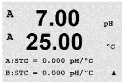
**STC**는 25 °C를 참조한 pH/°C 단위의 용액 온도 계수입니다(대부분의 응용 분야에서 기본값 = 0.000). 순수의 경우 0.016 pH/°C의 설정을 이용해야 합니다. 9 pH 근처의 낮은 전도도 발전소 샘플의 경우 0.033 pH/°C 설정을 사용해야 합니다. 이러한 양의 계수는 이러한 샘플의 pH에 대한 음의 온도 영향을 보상합니다. [ENTER]를 누릅니다.
