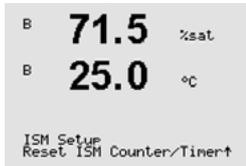
pH 센서 또는 전류 산소 센서가 연결된 경우 유지 보수 시기에 대한 메뉴가 표시됩니다. 유지 보수 시기는 다음 작동 후에 리셋되어야 합니다.
