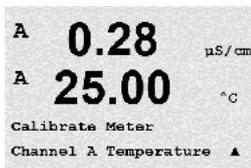
첫 번째 텍스트 라인에서는 Point 1 온도 저항값(이는 Calibration Module Accessory에 표시된 Temperature 1값에 해당)을 물어봅니다. 두 번째 텍스트 라인에 측정된 저항 값을 표시합니다. 값이 안정화되면 [ENTER]를 눌러 교정을 수행합니다.
