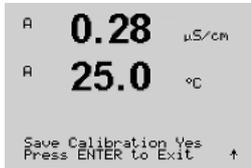
Point 1과 2가 교정되면 Calibrate Meter 화면으로 돌아갑니다. 커서를 Resistance 2으로 바꿔도록 이동하여 두 번째 교정 범위를 나타냅니다. 첫 번째 범위에 수행된 것처럼 2점 교정 공정을 진행합니다. 같은 공정을 따라 모든 5개 범위의 저항 교정을 완료합니다.
