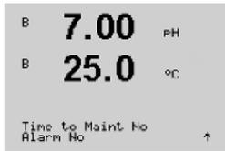
**Time to Maintenance:** 이 타이머는 가능한 최고의 측정 성능을 유지하도록 다음 세척 사이클이 수행되어야 하는 시기를 추정합니다. 이 타이머는 DLI 파라미터의 중대한 변경에 의해 영향을 받습니다.
