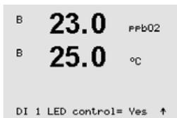
센서 LED의 작동 모드는 또한 트랜스미터의 디지털 입력 신호 DI1에 의해 영향을 받습니다. 파라미터 “DI 1 LED 제어”가 예로 설정되고 DI1이 활성화된 경우 LED가 꺼집니다. “DI 1 LED 제어”가 아니므로 설정되면 DI1의 신호는 이제 센서 LED의 작동 모드에 영향을 미치게 됩니다.
