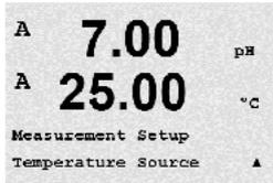
8.2 "측정"에서 설명한 대로 측정을 입력합니다. ▲ 또는 ▼ 키를 이용하여 Temperature Source를 선택하고 [ENTER] 키를 누르십시오.
