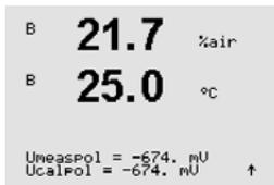
ISM 센서가 각각 연결되고 구성된 경우 센서에 대한 분극화 전압을 조정할 수 있는 더 많은 옵션을 설정할 수 있습니다. 측정 모드(Umeaspol) 및 교정 모드(Ucalpol)에는 다른 값이 입력될 수 있습니다. 0 mV 에서 -550 mV 사이에 입력된 값에 대해 연결된 센서는 -500mV의 분극화 전압이 설정될 것입니다. 입력된 값이 -550mV 보다 작을 경우 연결된 센서는 -674mV의 분극화 전압이 설정될 것입니다.
