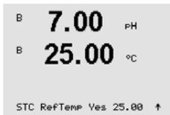
**STC RefTemp**는 용액 온도 보상에 관련된 온도를 설정합니다. 표시된 값과 출력 신호는 STC RefTemp로 연계됩니다. "아니오"를 선택하는 경우 용액 온도 보상이 사용되지 않음을 의미합니다. 가장 일반적인 기준 온도는 25°C입니다. [ENTER]를 누릅니다.
