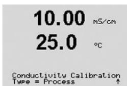
Process Calibration을 선택하고 [ENTER]를 누릅니다. 전도도 센서의 경우 공정 교정은 항상 기울기 교정으로 수행됩니다.
