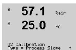
Un étalonnage de procédé de sondes à oxygène est toujours un étalonnage de la pente ou un étalonnage du décalage.
