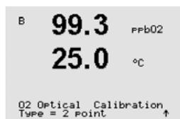
Sélectionnez le type d'étalonnage en deux points. Appuyez sur [ENTER].
