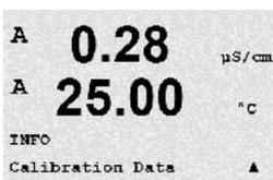
La sélection de Données Calibrage permet d'afficher les constantes d'étalonnage pour chaque sonde.
