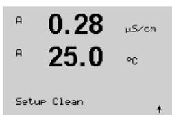
L'intervalle du cycle de nettoyage peut être réglé de 0,000 à 999,9 heures. Un réglage sur 0 désactive le cycle de nettoyage. La durée du nettoyage peut être comprise entre 0 et 9 999 secondes et doit être inférieure à l'intervalle du cycle de nettoyage.
