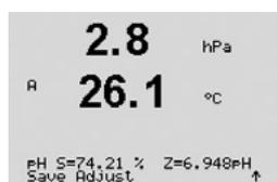
L'écran indique le facteur « S » d'étalonnage de la pente et le facteur « Z » d'étalonnage du décalage.
