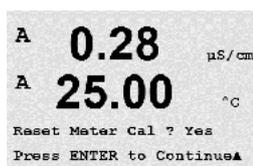
Après la sélection, appuyez sur la touche [ENTER] pour afficher un message de confirmation. Sélectionnez Non pour revenir au mode Mesure sans modification. Sélectionnez Oui pour réinitialiser les facteurs d'étalonnage de l'appareil.
