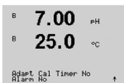
Activation de la **Minuterie d'étalonnage adaptatif** : Cette minuterie (Adapt Timer Cal) estime le moment où doit être effectué le prochain étalonnage pour assurer la meilleure performance de mesure. Elle tient compte des modifications importantes apportées aux paramètres DLI.
