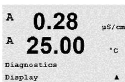
Tous les pixels de l'écran s'allument pendant 15 secondes pour permettre de déceler les éventuels problèmes. Au bout de 15 secondes, le transmetteur revient au mode de mesure normal ; pour quitter plus tôt, appuyez sur [ENTER].
