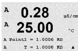
La première ligne de texte demande la valeur de température du point 1 (cela correspond à la valeur de la température 1 affichée sur le module d'étalonnage). La seconde ligne de texte indique la valeur de résistance mesurée. Lorsque la valeur se stabilise, appuyez sur [ENTER] pour effectuer l'étalonnage.
