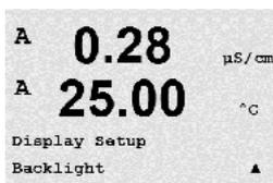
Les paramètres disponibles sont Act., Act. 50% ou Auto 50%. Si l'option Auto 50% est sélectionnée, le rétroéclairage est réduit à 50 % de ses capacités après 4 minutes d'inactivité au niveau du clavier. Le rétroéclairage s'active de nouveau automatiquement si une touche est enfoncée.
