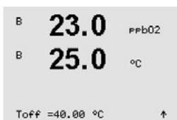
Selon la température du milieu mesurée, la DEL de la sonde peut s'éteindre automatiquement. Si la température du fluide est supérieure à Toff, la DEL s'éteindra. La DEL s'allumera dès que la température du milieu sera inférieure à Toff - 3K. Cette fonction permet d'accroître la durée de vie de l'OptoCap en éteignant la DEL par l'intermédiaire des cycles SEP ou NEP.
