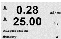
Si le menu Mémoire est sélectionné, le transmetteur effectue un test sur la mémoire vive (RAM) et la mémoire morte (ROM). Des modèles de test sont écrits sur tous les emplacements de la mémoire vive, d'autres sont lus à partir de ces mêmes emplacements. La somme de contrôle ROM est recalculée et comparée à la valeur enregistrée dans la mémoire morte.
