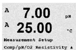
En fonction de la sonde branchée, vous pouvez sélectionner le menu pH, O<sub>2</sub>, CO<sub>2</sub> à l'aide des touches ▲ ou ▼. Appuyez sur [ENTER].
