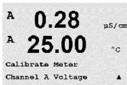
Saisissez la valeur en volts pour le Point 1 connecté à l'entrée. La tension mesurée est affichée sur la deuxième ligne. Appuyez sur [ENTER] pour démarrer le calibrage.
