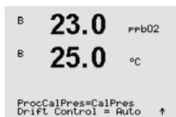
La pression appliquée (ProcCalPres) doit être définie pour l'algorithme d'étalonnage procédé. La valeur de la pression de procédé (ProcPres) ou de la pression d'étalonnage (CalPres) peut être utilisée. Choisissez la pression à appliquer lors de l'étalonnage procédé en fonction de l'algorithme.
