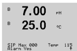
Le nombre max. de cycles SEP compte le nombre de cycles SEP. Si la limite (définie par l'utilisateur) est atteinte, une alarme apparaît à l'écran. L'interface FF vous permet de lire la limite de cycle SEP fournie par le bloc d'entrée discrète. L'option suivante est disponible :
