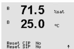
Si une sonde à oxygène est branchée, le menu de réinitialisation des compteurs NEP et SEP s'affiche. Ces compteurs doivent être réinitialisés après les opérations suivantes.
