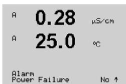
Pour sélectionner Alarm event (alarme), appuyez sur les touches ▲ ou ▼. Pour passer à « No/Yes », appuyez sur les touches ◀ et ▶. Confirmez la sélection en appuyant sur [ENTER].
