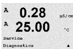
Ce menu est un outil précieux pour le dépannage et permet de diagnostiquer les éléments suivants : Modèle/Version logicielle, Affichage, Clavier, Mémoire, Read Analog Inputs, Optique O2.
