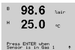
Placez la sonde dans la solution ou le gaz d'étalonnage (par exemple de l'air). Appuyez sur [ENTER].
