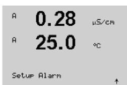
Ce menu permet de configurer la fonction d'alarme pour l'écran. L'interface FF vous permet de lire l'état de d'alarme fourni par le bloc d'entrée discrète. Pour plus d'informations, consultez la documentation « FOUNDATION fieldbus parameter Multi-parameter Transmitter M400 FF » sur CD-ROM.
