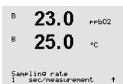
L'intervalle de temps entre deux cycles de mesure de la sonde peut être ajusté, c'est-à-dire adapté à l'application. Une valeur élevée prolongera la durée de vie de l'OptoCap de la sonde.
