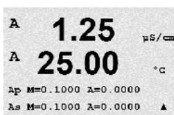
Toutes les constantes d'étalonnage pour le canal de sonde sélectionné s'affichent. Les constantes de mesure principales (p) sont affichées sur la ligne 3. Les constantes de la mesure (température) secondaire(s) de la sonde sont affichées sur la ligne 4.
