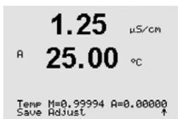
Après l'étalonnage, les valeurs d'étalonnage peuvent être prises en compte (Ajustage) ou non (Calibrer) ou l'opération peut être annulée (Annuler).
