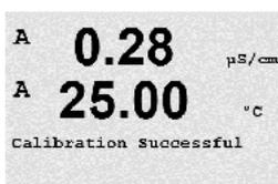
Le transmetteur revient en mode de mesure au bout de 5 secondes environ.
