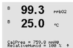
Réglez la pression d'étalonnage (CalPres) et l'humidité relative (RelativeHumid) appliquées lors de l'étalonnage. Appuyez sur [ENTER].
