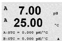
**STC** représente le coefficient de température de la solution en pH/°C à 25 °C (valeur par défaut = 0,000 pour la plupart des applications). Pour l'eau pure, une valeur de 0,016 pH/°C doit être utilisée. Pour des échantillons de centrales thermiques à faible conductivité, proche de 9 pH, une valeur de 0,033 pH/°C doit être utilisée. Ces coefficients positifs compensent l'influence négative de la température sur le pH de ces échantillons. Appuyez sur [ENTER].
