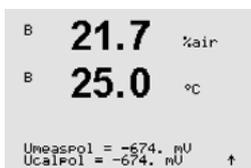
Si une sonde ISM a été branchée ou configurée, vous pouvez également ajuster la tension de polarisation de la sonde. Vous pouvez saisir des valeurs différentes pour le mode Mesure (Umeaspol) et pour le mode Calibrage (Ucalpol). Pour des valeurs saisies se situant entre 0 mV et -550 mV, la sonde branchée sera paramétrée à une tension de polarisation de -500 mV. Si la valeur saisie est inférieure à -550 mV, la sonde branchée sera paramétrée à une tension de polarisation de -674 mV.
