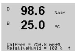
Réglez la pression d'étalonnage (CalPres) et l'humidité relative (HumidRelative) appliquées lors de l'étalonnage. Appuyez sur [ENTER].
