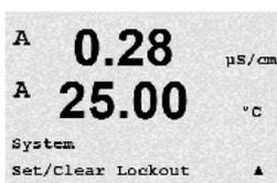
Ce menu permet d'activer/de désactiver la fonction de verrouillage du transmetteur. L'utilisateur est invité à saisir un mot de passe pour pouvoir accéder aux menus si la fonction **Verrouillage** est activée.
