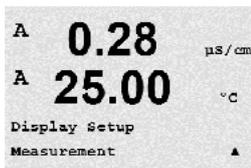
Cette sélection s'effectue dans le menu Configuration/Measurement/Channel Setup.
