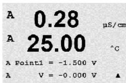
Saisissez la valeur en volts pour le point 2 de la source connectée à l'entrée. La tension mesurée est affichée sur la deuxième ligne.
