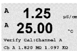
Le signal mesuré pour la mesure principale et secondaire s'affiche dans l'unité électrique. Les facteurs d'étalonnage de l'appareil de mesure sont utilisés lors du calcul de ces valeurs.
