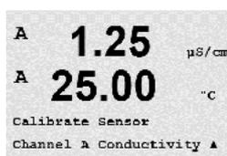
En mode Mesure, appuyez sur la touche ►. Si vous êtes invité à saisir le code de sécurité de l'étalonnage, appuyez sur la touche ▲ ou ▼ pour régler le mode de sécurité de l'étalonnage, puis sur [ENTER] pour confirmer le code de sécurité.
