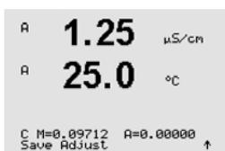
Une fois que l'étalonnage de cellule a été effectué, le multiplicateur ou facteur « M » d'étalonnage de la pente, c'est-à-dire la constante de cellule, et l'additionneur ou facteur « A » d'étalonnage du décalage sont affichés.
