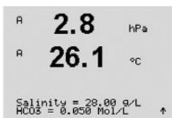
La **salinité (Salinity)** indique la quantité totale de sels dissous dans l'électrolyte de CO<sub>2</sub> de la sonde connectée au transmetteur. Il s'agit d'un paramètre spécifique à la sonde. La valeur par défaut (28,00 g/L) est valable pour le modèle InPro 5000. Ne modifiez pas ce paramètre si vous utilisez le modèle InPro 5000.
