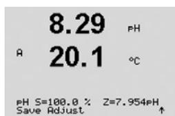
L'écran indique à présent le facteur « S » d'étalonnage de la pente et le facteur « Z » d'étalonnage du décalage.
