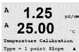
Sélectionnez Calibrage 1 point. Il est possible de sélectionner un étalonnage de la pente ou du décalage avec l'étalonnage en un point. Sélectionnez Pente pour recalculer le facteur M (Multiplicateur) de pente ou Offset pour recalculer le facteur A (Additionneur) d'étalonnage du décalage.
