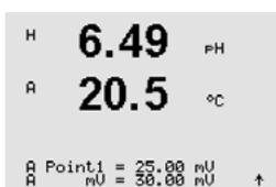
L'utilisateur peut à présent saisir le Point 1. Le facteur d'étalonnage du décalage est calculé en utilisant la valeur du point 1 à la place de la valeur mesurée (ligne 4,  $mV = \dots$ ), puis est affiché dans l'écran suivant.
