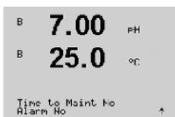
**Temps avant Maint :** Cette minuterie estime le moment où doit être effectué le prochain cycle de nettoyage pour assurer la meilleure performance de mesure. Elle tient compte des modifications importantes apportées aux paramètres DLI.
