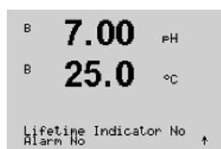
**Indicateur durée de vie** : L'indication dynamique de durée de vie permet d'estimer, d'après les contraintes réelles subies, à quel moment l'électrode de pH ou l'élément sensible d'une sonde à oxygène ampérométrique arrive en fin de vie. La sonde prend toujours en compte la contrainte moyenne des derniers jours et peut augmenter/réduire la durée de vie en fonction du résultat.
