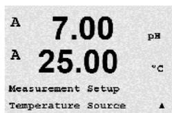
Accédez au mode Mesure comme indiqué à la section 8.2, « Mesure ». Sélectionnez Source Température en appuyant sur la touche ▲ ou ▼, puis appuyez sur [ENTER].
