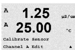
Accédez au mode Calibrage comme indiqué à la section 7.1, « Accès au mode Étalonnage », puis sélectionnez Edit, Edit pH ou Edit mV.
