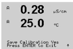
Une fois les points 1 et 2 étalonnés, revenez à l'écran Calibrer Transm. Déplacez le curseur pour passer à la Résistance 2, désignant la deuxième plage d'étalonnage. Continuez avec le procédé d'étalonnage en deux points comme pour la première plage. Le même procédé doit être suivi pour réaliser l'étalonnage de la résistance des 5 plages.
