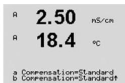
La **compensation standard** comprend une compensation des effets de la pureté élevée non linéaire ainsi que des impuretés des sels neutres traditionnels. Elle est conforme aux normes ASTM D1125 et D5391.
