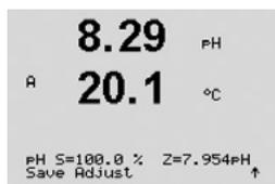
Dès que les critères de stabilisation sont remplis, l'affichage change. L'écran indique à présent le facteur « S » d'étalonnage de la pente et le facteur « Z » d'étalonnage du décalage.
