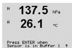
Placez l'électrode dans la première solution tampon et appuyez sur la touche [ENTER] pour démarrer l'étalonnage.
