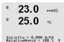
De plus, l'humidité relative du gaz d'étalonnage peut également être saisie. Les valeurs autorisées pour l'humidité relative sont comprises entre 0 % et 100 %. Lorsqu'aucune mesure d'humidité n'est disponible, utilisez 50 % (la valeur par défaut).
