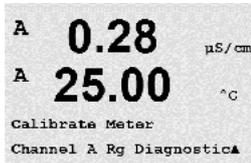
Saisissez la valeur du Point 1 de l'étalonnage en fonction de la résistance connectée via l'entrée de mesure de l'électrode de verre pH. Appuyez sur [ENTER] pour démarrer l'étalonnage.
