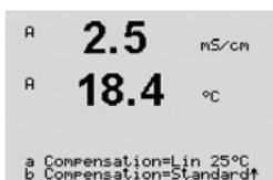
La **compensation linéaire 25 °C** ajuste la lecture au moyen d'un coefficient ou facteur exprimé en « % par °C » (écart par rapport à 25 °C). À n'utiliser que si la solution a un coefficient de température linéaire bien défini.
