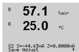
Une fois l'étalonnage effectué, le facteur « S » d'étalonnage de la pente et le facteur « Z » d'étalonnage du décalage sont affichés.
