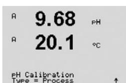
Sélectionnez Calibrage procédé. Avec les électrodes de pH, un étalonnage de procédé est toujours réalisé comme un étalonnage du décalage.
