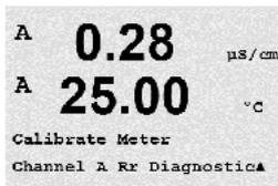
L'étalonnage Diagnostic Rr s'effectue en deux points. Accédez à l'écran Calibrer Transm. et sélectionnez le canal A et Diagnostic Rr.
