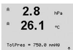
Si l'unité pour le CO<sub>2</sub> dissous mesuré est %sat, il faut tenir compte de la pression pendant l'étalonnage ou la mesure. Pour cela, il convient de régler le paramètre TotPres.
