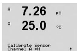
Accédez au mode Calibrage de pH comme indiqué dans la section 7.1, « Accès au mode Étalonnage ».
