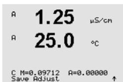
Une fois que l'étalonnage de la cellule a été effectué, le multiplicateur ou facteur « M » d'étalonnage de la pente, c'est-à-dire la constante de cellule, et l'additionneur ou facteur « A » d'étalonnage du décalage sont affichés.
