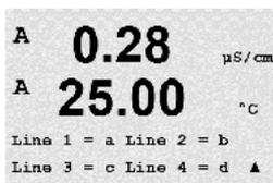
Sélectionnez le mode « Erreur Affichage ». Si ce paramètre est activé, lorsqu'une alarme ou un avertissement survient, le message « Erreur – Presser ENTER » s'affiche sur la ligne 4 en mode de mesure normal.
