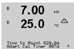
Les valeurs initiales du délai de maintenance et de la minuterie d'étalonnage adaptatif peuvent être modifiées en fonction de l'expérience concernant l'application et chargées sur la sonde.
