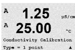
Sélectionnez Calibrage 1 point et appuyez sur [ENTER]. Avec les sondes de conductivité, un étalonnage en un point est toujours réalisé comme un étalonnage de la pente.
