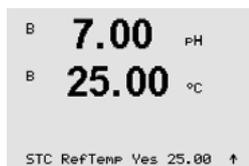
**STC RefTemp** permet de définir la température à laquelle correspond la compensation de température de la solution. La valeur affichée et le signal de sortie renvoient à ce paramètre. Si vous sélectionnez « Non », la compensation de température de la solution ne sera pas employée. La température de référence la plus courante est 25 °C. Appuyez sur [ENTER].
