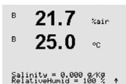
À l'étape suivante, la salinité de la solution mesurée peut être modifiée.
