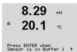
Placez l'électrode dans la solution tampon et appuyez sur la touche [ENTER] pour démarrer l'étalonnage.
