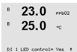
Le mode de fonctionnement de la DEL de la sonde peut également être influencé par le signal d'entrée numérique DI1 du transmetteur. Si le paramètre « DI 1 LED control » est réglé sur Oui, la DEL est désactivée lorsque DI1 est actif. Si le paramètre « DI 1 LED control » est réglé sur Non, le signal de DI1 influence le mode de fonctionnement de la DEL de la sonde.
