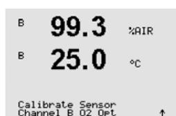
Accédez au mode d'étalonnage O<sub>2</sub> opt, comme indiqué dans la section 7.1 sur l'accès au mode d'étalonnage.
