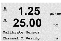
Accédez au mode Calibrage comme indiqué à la section 7.1, « Accès au mode Étalonnage », puis sélectionnez Vérifier.
