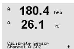
Sélectionnez l'étalonnage en 1 point. Avec les sondes CO<sub>2</sub>, un étalonnage en un point est toujours réalisé comme un étalonnage du décalage.
