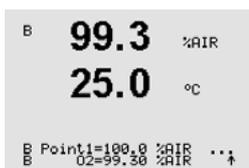
Sélectionnez le type d'étalonnage en un point. Appuyez sur [ENTER].
