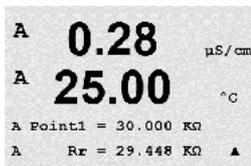
Saisissez la valeur du Point 1 de l'étalonnage en fonction de la résistance connectée via l'entrée de mesure de la référence pH. Appuyez sur [ENTER] pour démarrer l'étalonnage.
