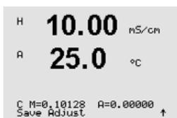
Une fois que l'étalonnage a été effectué, le multiplicateur ou facteur « M » d'étalonnage de la pente et l'additionneur ou facteur « A » d'étalonnage du décalage sont affichés.
