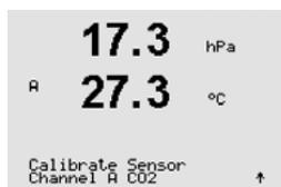
Sélectionnez l'étalonnage procédé. Avec les sondes de CO<sub>2</sub>, un étalonnage procédé est toujours réalisé comme un étalonnage du décalage.
