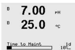
**Temps avant Maint :** Cette minuterie indique le moment où doit être effectué le prochain cycle de nettoyage pour assurer les meilleures performances de mesure. Le délai de maintenance est indiqué en jours (d) et pourcentage (%). La section 8.4 « Configuration ISM (pour sondes ISM, pH, oxygène et CO<sub>2</sub> dissous) », fournit une description du délai de maintenance. Pour les sondes à oxygène, le délai de maintenance représente un cycle de maintenance pour la membrane et l'électrolyte.
