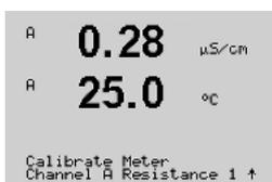
Accédez à l'écran d'étalonnage du transmetteur et sélectionnez la voie A ou B, et la résistance 1, pour indiquer que le transmetteur est prêt à étalonner la résistance de la première plage. Il est possible de modifier cette résistance en sélectionnant la plage de 1 à 5. Chaque plage de résistance se compose d'un étalonnage en deux points.
