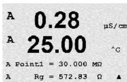
Saisissez la valeur du Point 2 de l'étalonnage en fonction de la résistance connectée via l'entrée de mesure de l'électrode de verre pH.
