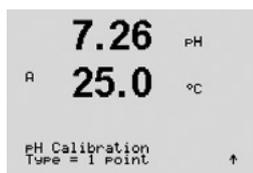
Sélectionnez Calibrage 1 point. Avec les électrodes de pH, un étalonnage en un point est toujours réalisé comme un étalonnage du décalage.
