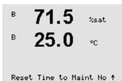
Si une électrode de pH ou une sonde à oxygène ampérométrique est branchée, le menu de réinitialisation du délai de maintenance s'affiche. Le délai de maintenance doit être réinitialisé après les opérations suivantes.
