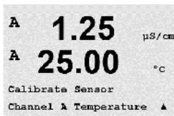
Accédez au mode Calibrage de la sonde comme indiqué à la section 7.1, « Accès au mode Étalonnage » et sélectionnez Température.
