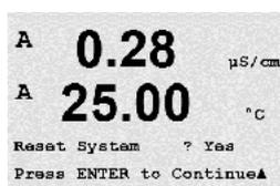
Après la sélection, appuyez sur la touche [ENTER] pour afficher un message de confirmation. Sélectionnez Non pour revenir au mode Mesure sans modification. Sélectionnez Oui pour réinitialiser l'instrument.
