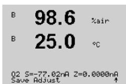
Une fois que l'étalonnage a été effectué, le facteur « S » d'étalonnage de la pente et le facteur « Z » d'étalonnage du décalage sont affichés.
