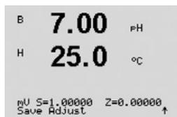
Si vous sélectionnez « Ajustage » ou « Calibrer », le message « Calibrage Réussier » s'affiche. Dans tous les cas, les messages « Reinstallation electrode » et « ENTER » s'affichent. Lorsque vous avez appuyé sur « ENTER », le M400 revient au mode de mesure.
