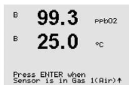
Placez la sonde dans la première solution ou le premier gaz d'étalonnage (par exemple de l'air). Appuyez sur [ENTER].
