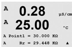
Introduzca el valor para el punto 1 de la calibración de acuerdo con la resistencia conectada en la entrada de medición de referencia de pH. Pulse [ENTER] para iniciar el proceso de calibración.
