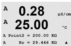
Introduzca el valor para el punto 2 de la calibración de acuerdo con la resistencia conectada en la entrada de medición de referencia de pH.
