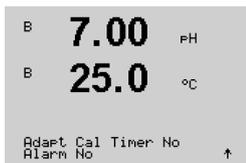
Activación del **Adapt Tiemp Cal:** este temporizador estima cuándo debe realizarse la siguiente calibración para mantener el mejor rendimiento de medición posible. El temporizador se ve influenciado por cambios significativos en los parámetros DLI.
