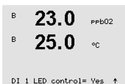
El modo de funcionamiento del sensor LED también puede estar influido por la señal de entrada digital DI1 del transmisor. Si el parámetro «DI 1 LED control» está en «Sí», el LED está apagado si DI1 está activa. Si el parámetro «DI 1 LED control» está en «No», la señal de DI1 influye en el modo de funcionamiento del sensor LED.
