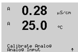
La entrada analógica se puede calibrar con dos valores de corriente, p. ej., 4 y 20 mA.
