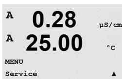
En el modo de medición, pulse la tecla ◀. Pulse la tecla ▲ o ▼ para navegar hasta el menú «Servicio» y pulse [ENTER]. A continuación, se detallan las opciones de configuración de sistema disponibles.
