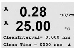
El intervalo de limpieza puede ajustarse de 0,000 a 999,9 horas. Si se ajusta a 0, se desactiva el ciclo de limpieza. El tiempo de limpieza puede estar entre 0 y 9999 segundos y debe ser inferior al intervalo de limpieza.
