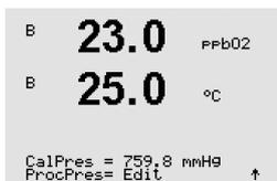
Introduzca la presión de calibración (línea 3). El valor por defecto para «CalPres» es 759,8 y la unidad por defecto es mmHg.
