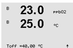
El LED del sensor puede apagarse automáticamente según la temperatura medida en los medios. Si la temperatura en los medios es superior a Toff, el LED se apagará. El LED se encenderá cuando la temperatura en los medios sea inferior a Toff - 3K. Esta función permite aumentar el tiempo de vida útil del OptoCap si se apaga el LED durante los ciclos SIP o CIP.
