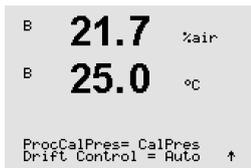
Debe definirse la presión aplicada para el algoritmo de la calibración de proceso (ProcCalPres). Puede utilizarse el valor de la presión de proceso (ProcPres) o la presión de calibración (CalPres). Seleccione la presión que se aplique durante la calibración del proceso o que debe utilizarse para el algoritmo.
