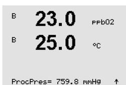
Si ha seleccionado «Cambiar» aparecerá un campo de entrada para introducir el valor de forma manual. En el caso de que haya seleccionado «Ain», hay que introducir el valor del principio (4 mA) y el valor del final (20 mA) del intervalo para la señal de entrada de 4 a 20 mA.
