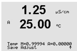
Tras una calibración satisfactoria, los valores de calibración se toman y se almacenan en el historial de calibración (Ajuste), solo se almacenan en el historial de calibración (Calibrar) o se eliminan.
