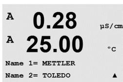
La pantalla resultante en el modo de medición aparece en las líneas 3 y 4 por delante de las mediciones.
