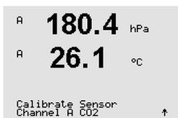
Entre en el modo de calibración de CO<sub>2</sub>, como se describe en el apartado 7.1 «Entrar en el modo de calibración».
