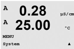
En el modo de medición, pulse la tecla ◀. Pulse la tecla ▼ o ▲ para navegar hasta el menú «Sistema» y pulse [ENTER].
