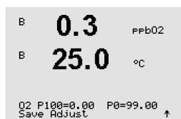
Si escoge «Ajuste» o «Calibrar», en la pantalla aparecerá el mensaje «Calibrado con éxito». En cualquier caso, en la pantalla aparecerá el mensaje «Reinstalar sensor» y «Apriete ENTER». Después de pulsar «ENTER», el M400 vuelve al modo de medición.
