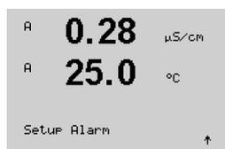
Para seleccionar «Evento de alarma», pulse la tecla ▲ o ▼. Para desplazarse a «No / Sí», pulse las teclas ◀ y ▶. Confirme la selección con [ENTER].
