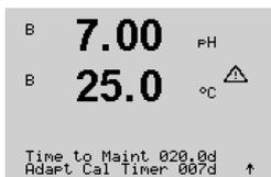
El valor inicial de Tiempo a Manten y del Adapt Tiemp Cal pueden modificarse según el uso de la aplicación y descargar en el sensor.
