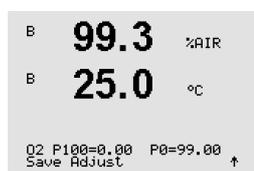
La pantalla cambia cuando se cumplen los criterios de estabilización. Se muestran los valores de la fase del sensor al 100 % de aire (P100) y al 0 % de aire (P0).
