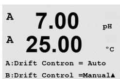
Pour la reconnaissance automatique du tampon lors de l'étalonnage, sélectionnez le jeu de solutions tampons utilisé : Mettler-9, Mettler-10, NIST Tech, NIST Std, HACH, CIBA, MERCK, WTW ou None (Aucun). Voir la section 19, « Tableaux de tampons », pour les valeurs des tampons. Si la fonction de tampon automatique n'est pas utilisée ou si les tampons disponibles diffèrent des tampons ci-dessus, sélectionnez « Aucune ».
