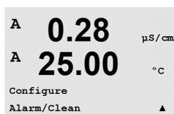
Accédez au mode Configuration conformément à la description de la section 8.1 «Accès au mode Configuration».
