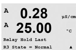
Sélectionnez « Inversé » pour inverser le mode de fonctionnement normal du relais (par exemple, les contacts normalement ouverts sont en position fermée et les contacts normalement fermés sont en position ouverte, jusqu'à ce que le seuil soit dépassé). Le fonctionnement « Inversé » du relais est effectif lorsque le transmetteur M200 est mis sous tension.
