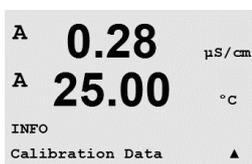
La sélection de Données Calibrage permet d'afficher les constantes d'étalonnage pour chaque sonde. Utilisez les touches Haut et Bas pour basculer entre les canaux A et B.
