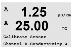
Accédez au mode Étalonnage de la sonde conformément à la description de la section 7.1 «Accès au mode Étalonnage».
