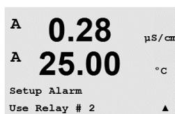
Utilisez les touches ◀ et ▶ pour accéder à Use Relay #. À l'aide de la touche ▲ ou ▼, sélectionnez le relais à utiliser pour l'alarme et appuyez sur [ENTER].
