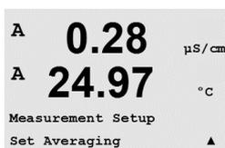
Appuyez sur la touche [ENTER] pour sélectionner ce menu. La méthode de la moyenne (filtre de bruit) pour chaque ligne de mesure peut désormais être sélectionnée. Les options sont Spécial (Par défaut), Aucune, Bas, Moyen et Haut :
