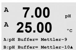
STC représente le coefficient de température de la solution en pH/°C à 25 °C (par défaut = 0,000 pour la plupart des applications). Pour l'eau pure, une valeur de 0,016 pH/°C doit être utilisée. Pour des échantillons de centrales électriques à faible conductivité, proche de 9 pH, une valeur de 0,033 pH/°C doit être utilisée. Ces coefficients positifs compensent l'influence négative de la température sur le pH de ces échantillons.
