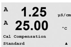
Après avoir sélectionné l'étalonnage de sonde souhaité et appuyé sur [ENTER], l'écran suivant propose de choisir le type de mode de compensation de température désiré lors du procédé d'étalonnage. Les choix sont Standard, Light 84, Std 75 °C, Lin 20 °C = 02.0%/°C (valeur sélectionnable par l'utilisateur), Lin 25 °C = 02.0%/°C (valeur sélectionnable par l'utilisateur), Glycol.5, Glycol1, Alcohol et Nat H<sub>2</sub>O.
