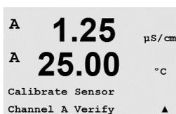
Accédez au mode Calibration (Étalonnage) conformément à la description de la section 7.1 «Accès au mode Étalonnage» et sélectionnez Verify (Vérifier).
