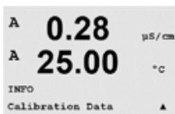
La sélection de « Calibration Data » (Données Calibrage) permet d'afficher les constantes d'étalonnage pour chaque sonde.
