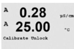
Sélectionnez « Yes » (Oui) pour que les menus d'étalonnage de l'instrument et des sorties courant soient accessibles sous le menu CAL. Si vous sélectionnez « No » (Non), seul l'étalonnage de la sonde sera disponible dans le menu CAL. Après la sélection, appuyez sur [ENTER] pour afficher un message de confirmation.
