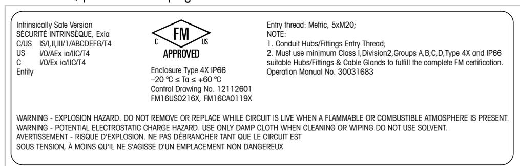
Figure 4 : Modèle d'étiquettes M400/2XH, M400G/2XH
