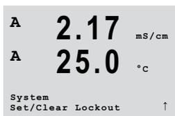
Ce menu permet d'activer/de désactiver la fonction de verrouillage du transmetteur. L'utilisateur est invité à saisir un mot de passe pour pouvoir accéder aux menus si la fonction de verrouillage est activée.
