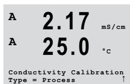
Sélectionnez le type d'étalonnage, ici « Process » (Procédé). L'étalonnage de procédé est toujours réalisé comme un étalonnage de la pente.
