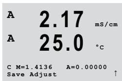
Résultat : une fois l'étalonnage effectué, l'écran affiche le multiplicateur ou facteur « M » d'étalonnage de la pente et l'additionneur ou facteur « A » d'étalonnage du décalage.
