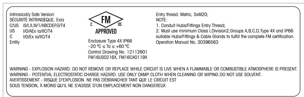
Figure 5 : Modèle d'étiquettes M400/2XH Cond Ind
