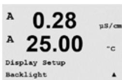
Les paramètres disponibles sont « On » (Act.), « On 50% » (Act. 50%) et « Auto Off 50% » (Auto 50%). Si l'option « Auto Off 50% » (Auto 50%) est sélectionnée, le rétroéclairage est réduit à 50 % de ses capacités après 4 minutes d'inactivité au niveau du clavier. Le rétroéclairage s'active de nouveau automatiquement si une touche est enfoncée.
