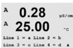
Sélectionnez le mode « Error Display » (Erreur Affichage). Si ce paramètre est activé, lorsqu'une alarme ou un avertissement survient, le message « Failure – Press ENTER » (Erreur – Presser ENTER) s'affiche sur la ligne 4 en mode de mesure normal.
