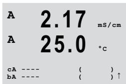
Konfigurieren Sie die dritte und vierte Zeile der Anzeige c und d. Drücken Sie die Tasten ► oder ◀, um zwischen den Messungen/Einheiten und Multiplikatoren umzuschalten. Drücken Sie die Taste ▲ oder ▼, um die Optionen auszuwählen.
