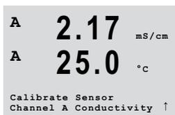
Drücken Sie im Messmodus die Taste [CAL (►)]. Falls die Anzeige Sie zur Eingabe des Sicherheitspasswortes für die Kalibrierung auffordert, drücken Sie zur Einrichtung dieses Passwortes die Taste ▲ oder ▼. Drücken Sie anschließend die Taste [ENTER], um das Sicherheitspasswort für die Kalibrierung zu bestätigen.
