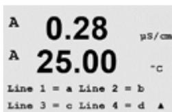
Wählen Sie den Modus «Error Display» (Fehleranzeige). Ist dieser nach Auslösen eines Alarms auf «On» (Ein) eingestellt, dann erscheint die Meldung «Failure – Press ENTER» (Fehler – ENTER drücken) in Zeile 4, wenn im normalen Messmodus ein Alarm ausgelöst wird.
