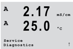
Dieses Menü ist ein wertvolles Hilfsmittel zur Fehlersuche und bietet Diagnosefunktionen für folgende Punkte: Model/Software Revision, Digitaler Eingang, Anzeige, Tastatur, Memory, Set Kontakte, Lese Kontakte, Set analoge Ausgänge und Lese analoge Ausgänge.
