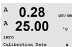
Die Auswahl «Calibration Data» (Justierdaten) zeigt die Kalibrierkonstanten für jeden Sensor an.
