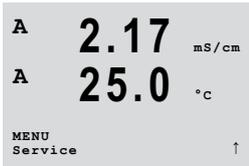
Drücken Sie im Messmodus die Taste ◀. Drücken Sie die Tasten ▲ oder ▼, um den Menüpunkt «Service» (Wartung) zu wählen, und drücken Sie [ENTER]. Die Optionen zur Systemkonfiguration werden nachfolgend beschrieben.
