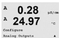
Navigieren Sie mit den Tasten ▲ oder ▼ zum Menü «Analog Outputs» (Analog Ausgänge).
