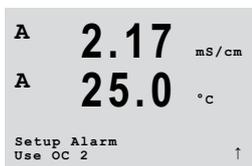
Gehen Sie mit den Tasten ◀ und ▶ zu «Use OC #» (OC Nr. verwenden). Wählen Sie mit den Tasten ▲ oder ▼ das Relais, das für den Alarm verwendet werden soll und drücken Sie [ENTER].
