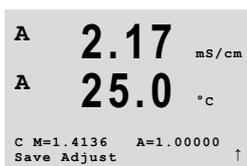
Ergebnis: Nach der Kalibrierung zeigt die Anzeige den Multiplikator oder Steilheitskalibrierfaktor «M» und den Additionsfaktor bzw. Offseffaktor «A» der Kalibrierung.
