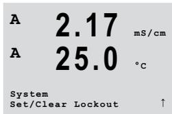
In diesem Menüpunkt können Sie die Sperrfunktion des Transmitters aktivieren/deaktivieren. Der Bediener wird bei eingeschalteter Sperrfunktion nach seinem Passwort gefragt, bevor er Zugriff auf die Menüs erhält.
