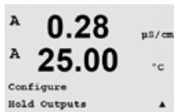
Navigieren Sie mit den Tasten ▲ oder ▼ zum Menü «Hold Outputs» (Hold Ausgänge).
