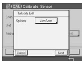
Appuyez sur le champ « Options » pour modifier la valeur du gain : Low/Low (faible/faible) (valeur par défaut), Low/High (faible/élevé) ou High/High (élevé/élevé). Plus le gain est élevé, plus l'étalonnage risque d'être interrompu à un niveau de turbidité plus élevé en raison de la saturation du signal. Dans ce cas, recommencez l'étalonnage avec un gain plus faible.
