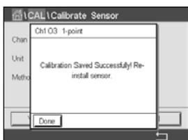
Si vous sélectionnez « Ajuster » ou « Calibrer », l'écran affiche le message « Calibration Saved Successfully! » (Sauvegarde de l'étalonnage réussie !). Dans tous les cas, le message « Veuillez réinstaller la sonde » s'affiche. Lorsque vous appuyez sur le bouton « Fait », le M800 revient au menu Étalonnage.
