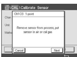
Placez la sonde dans le gaz d'étalonnage (l'air, par exemple), puis appuyez sur le bouton « Suivant ».
