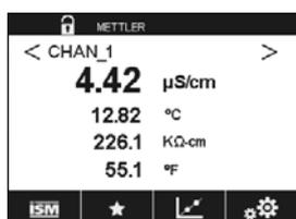
Après avoir déterminé la valeur de conductivité de l'échantillon, appuyez à nouveau sur l'icône de l'étalonnage dans la fenêtre de menu (voir la section 3.4.2 « Commandes »).
