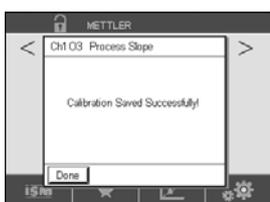
Si vous sélectionnez « Ajuster » ou « Calibrer », l'écran affiche le message « Calibration Saved Successfully! » (Sauvegarde de l'étalonnage réussie !). Lorsque vous appuyez sur le bouton « Fait », le M800 revient à la fenêtre de menu
