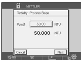
Appuyez sur le champ **Point1** pour saisir la valeur de turbidité de l'échantillon. Appuyez sur « Suivant » pour lancer le calcul des résultats de l'étalonnage.
