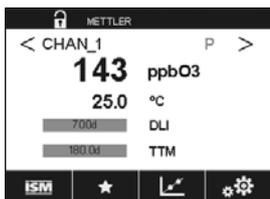
Après avoir déterminé la valeur d'ozone de l'échantillon, appuyez sur l'icône de l'étalonnage pour terminer l'étalonnage procédé.
