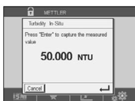
Prélevez un autre échantillon et appuyez sur le bouton ↵ pour mémoriser la mesure actuelle. Pour indiquer que le procédé d'étalonnage est en cours, un « C » clignote dans la fenêtre d'accueil et de menu si la voie concernée est sélectionnée dans la fenêtre.
