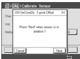
Placez l'électrode dans la solution de référence et appuyez sur le bouton « Suivant ».
