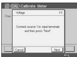
Connectez la source 1 aux terminaux d'entrée. Appuyez sur le bouton « Suivant » pour lancer l'étalonnage.
