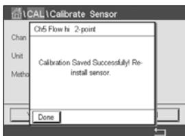
Si vous sélectionnez « Enregistrer », l'écran affiche les messages « Calibration Saved Successfully! » (Sauvegarde de l'étalonnage réussie !) et « Please re-install sensor » (Veuillez réinstaller la sonde). Lorsque vous appuyez sur le bouton « Fait », le M800 revient au menu Étalonnage.
