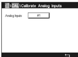
Chaque entrée analogique peut être étalonnée à 4 et 20 mA. Sélectionnez le signal d'entrée à étalonner en appuyant sur le bouton #1.
