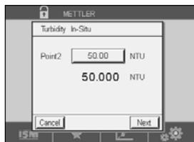
Appuyez sur le champ **Point2** pour saisir la valeur de turbidité de l'échantillon. Appuyez sur « Suivant » pour lancer le calcul des résultats de l'étalonnage.
