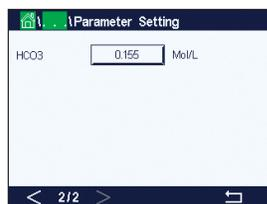
Der Parameter **HCO<sub>3</sub>** gibt die Konzentration des Hydrogencarbonats im CO<sub>2</sub>-Elektrolyten des an den Transmitter angeschlossenen Sensors an. Dieser Parameter ist ebenfalls sensorspezifisch. Der voreingestellte Wert von 0,050 mol/L gilt für den Sensor InPro 5000 i. Diesen Parameter keinesfalls ändern, wenn der InPro 5000 i verwendet wird.
