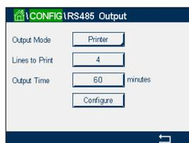
Zum Konfigurieren der Druckerausgabe wählen Sie unter «Ausgabemodus» die Option «Drucker». Verfügbar sind die folgenden Optionen:
