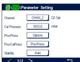
Wenn bei der Kanaleinrichtung (siehe Kapitel 8.1.1 «Kanaleinrichtung») die Option «Auto» gewählt und ein amperometrischer Sauerstoffsensor angeschlossen wurde, können die Parameter «KalDruck», «ProzDruck», «ProzKalDruck», «Stabilität», «Salzgehalt», «RelFeuchte», «Messrate», «LED-Modus» und «Toff» festgelegt oder justiert werden. Dieselben Parameter werden angezeigt, wenn bei der Kanaleinrichtung anstelle von «Auto» die Option «O<sub>2</sub> optisch» gewählt wurde.
