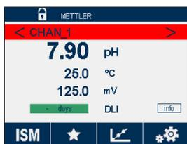
Bedingungen, die einen Alarm auslösen, werden durch einen roten Balken angezeigt. Wenn der betroffene Kanal in der aktuellen Menüansicht oder auf dem Startbildschirm angezeigt wird (siehe Kapitel 3.2 «Anzeige»), erscheint der rote Balken in der Zeile mit der Kanalanzeige. Eine Alarmmeldung wird aufgezeichnet und kann über das Menü «Meldungen» (PFAD: \ ISM \ Messages; siehe auch Kapitel 9.2 «Meldungen») aufgerufen werden.
