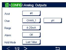
Drücken Sie das Eingabefeld in der Einstellungszeile für **Aout** und wählen Sie das zu konfigurierende Ausgangssignal durch Drücken der entsprechenden Schaltfläche («#1» für Ausgangssignal 1, «#2» für Ausgangssignal 2 usw.). Drücken Sie die zugehörige Schaltfläche für die Kanalzuweisung (**Kan**). Wählen Sie den Kanal, der mit dem Ausgangssignal verknüpft werden soll.
