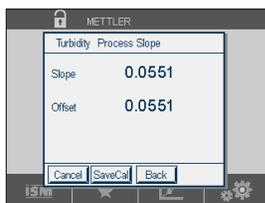
Als Ergebnis der Kalibrierung wird in der Anzeige der Wert für Steilheit und Nullpunktverschiebung (Offset) angezeigt.
