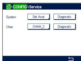
Wählen Sie über den Parameter **System** das zu diagnostizierende Element durch Drücken des entsprechenden Feldes aus.
