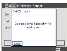
Wurden «Justierung» oder «Kalibrierung» ausgewählt, wird «Kalibrierung erfolgreich gespeichert» angezeigt. In jedem Fall wird die Meldung «Bitte Sensor neu installieren» angezeigt. Nach Drücken der Schaltfläche «Fertig» kehrt der M800 zum Kalibrieremenü zurück.
