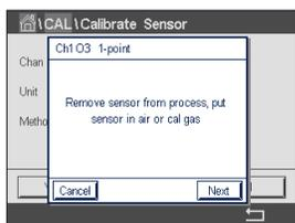
Halten Sie den Sensor in das Kalibriergas, z. B. Luft, und drücken Sie die Schaltfläche «Weiter».
