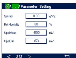
Zusätzlich kann die relative Feuchtigkeit des Kalibriergases über die Schaltfläche **Rel.Feuchte** eingegeben werden. Die relative Feuchtigkeit darf im Bereich von 0 % bis 100 % liegen. Wenn kein Messwert für Feuchtigkeit verfügbar ist, verwenden Sie die Voreinstellung «50 %».
