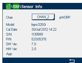
Die Daten des ersten Kanals, an den ein Sensor angeschlossen ist, werden auf dem Bildschirm angezeigt. Drücken Sie das Eingabefeld in der Zeile «Kan». Drücken Sie das zugehörige Feld, um den entsprechenden Kanal auszuwählen und die Daten des gewünschten Sensors einzusehen.
