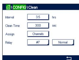
Geben Sie das **Reinigungsintervall** in Stunden ein. Das Reinigungsintervall kann auf 0,000 bis 999 Stunden eingestellt werden. Die Einstellung 0 bedeutet, dass der Reinigungszyklus ausgeschaltet ist.
