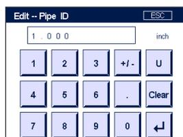
Drücken Sie das Eingabefeld für den Wert des Parameters **Pipe ID**. Das M800 zeigt ein Tastenfeld an, mit dem der Wert geändert werden kann. Bei Durchflussgeschwindigkeitsmessungen in ft/sec (Fuß pro Sekunde) wird der Innendurchmesser des Rohrs benötigt, in dem der Sensor installiert ist. Geben Sie den genauen Innendurchmesser in Zoll ein. Mit der  $\leftarrow$ -Taste übernehmen Sie den Wert.
