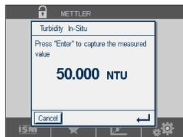
Nehmen Sie eine weitere Probe und drücken Sie die  $\leftarrow$ -Taste, um den aktuellen Messwert zu speichern. Die laufende Kalibrierung wird mit einem blinkenden «C» auf dem Startbildschirm und im Hauptmenü angezeigt, wenn der entsprechende Kanal in der Anzeige gewählt wurde.
