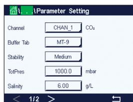
Wenn bei der Kanaleinrichtung (siehe Kapitel 8.1.1 «Kanaleinrichtung») die Option «Auto» oder «CO<sub>2</sub>» gewählt und ein Sensor für gelöstes Kohlendioxid angeschlossen wurde, können der für die Kalibrierung verwendete Puffer sowie die Parameter «Stabilität», «Salzgehalt», «HCO<sub>3</sub>» und «TotPres» festgelegt oder justiert werden.
