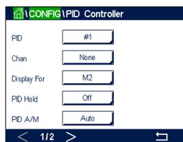
Der M800 bietet zwei PID-Regler. Drücken Sie das Eingabefeld in der Einstellungszeile für **PID** und wählen Sie den zu konfigurierenden PID-Regler durch Drücken der entsprechenden Schaltfläche («#1» für PID-Regler 1 und «#2» für PID-Regler 2).
