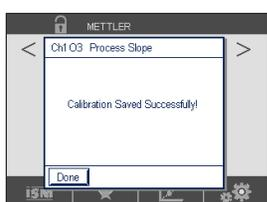
Wurden «Justierung» oder «Kalibrierung» ausgewählt, wird «Kalibrierung erfolgreich gespeichert» angezeigt. Nach Drücken der Schaltfläche «Fertig» kehrt der M800 zum Hauptmenü zurück.
