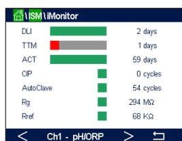
Der iMonitor des ersten Kanals wird auf dem Bildschirm angezeigt. Um den iMonitor nach den verschiedenen Kanälen zu durchsuchen, drücken Sie > am unteren Bildrand.
