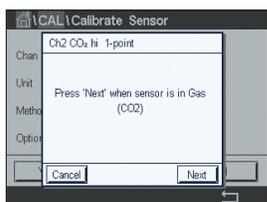
Bei Wärmeleitfähigkeitssensoren erfolgt eine Einpunktkalibrierung stets als Kalibrierung der Steilheit (Slope). Drücken Sie die Schaltfläche «Kal», um die Kalibrierung zu starten.
