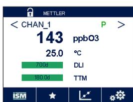
Nach der Bestimmung des O<sub>3</sub>-Gehalts der Probe, drücken Sie auf das Kalibriersymbol, um die Prozesskalibrierung abzuschließen.
