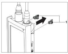
2 Spingere l'unità di stabilizzazione della base del misuratore (1) nei recessi (2) dello strumento.
