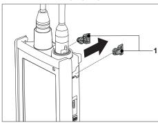
Spingere il portasensore (1) nel recesso (2) dello strumento.
