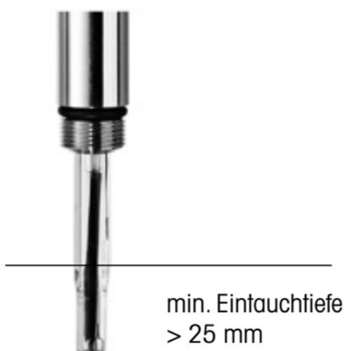
Innenkörper (pH-Elektrode) gemäss Beschreibung in Kapitel 4.1 „Start-up“ vorbereiten. Für den analogen CO<sub>2</sub> Sensor InPro 5000 empfehlen wir eine 2-Punkt-Kalibrierung in pH-Puffer pH 7.00 und pH 9.21. Vor der Kalibrierung Wässerungskappe entfernen. In pH-Puffer pH 7.00 wird der Nullpunkt und in Puffer pH 9.21 die Steilheit der pH-Messkette kalibriert. Bitte die Anweisungen in der Betriebsanleitung des Transmitters beachten.
