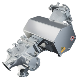
在线清洗型金属检测系统 通过 OEB5 认证，增设多向喷淋喷嘴，可对传输通道及剔除系统进行清洁与除污。
