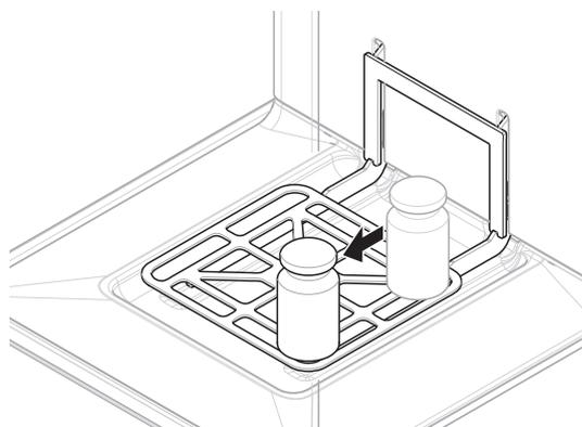
13 丁寧に試験荷重を降ろして、**✓ OK**をタップします
