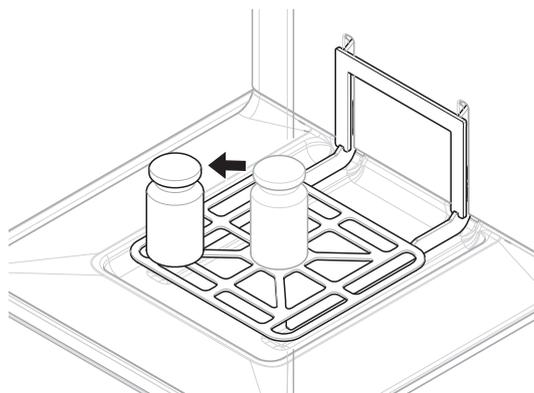
10 試験荷重を吊り上げ、位置3に移動します（計量皿の左後ろ端）。
