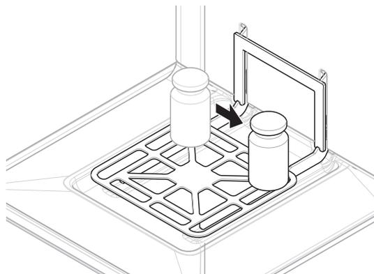
12 試験荷重を吊り上げ、位置5に移動します（計量皿の左前端）。
