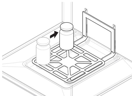
11 試験荷重を吊り上げ、位置4に移動します（計量皿の右後ろ端）。
