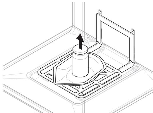
11 Posizionare con cautela il peso di prova (3) sul piatto di pesata o nel contenitore (4).
