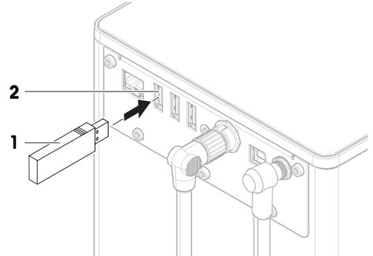
1 Conecte el adaptador USB de Bluetooth (1) a uno de los puertos USB-A (2) de la balanza.
