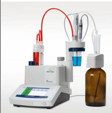
Der Kontakt mit flüssigen Chemikalien ist stets zu vermeiden. Daher übernimmt der Solvent Manager das Einfüllen, Entleeren und Erneuern von Lösungsmitteln. Er wird vollständig vom Titrator gesteuert, der einen OneClick-Zugang zu allen Tasks bietet. Darüber hinaus überwacht LevelSens die Lösung und verhindert ein Überlaufen der Abfallflasche, wodurch die Sicherheit noch weiter erhöht wird.
