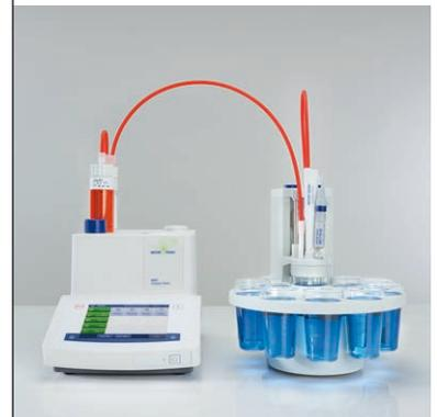
Der automatische Rondolino-Titrierstand ist einfach zu installieren und benötigt nur äusserst wenig Platz auf dem Labortisch. Probenserien von bis zu neun Proben werden schnell und sicher verarbeitet. Zudem wird nach erfolgter Titration der Sensor zur sicheren Aufbewahrung in den Konditionierbecher gefahren.
