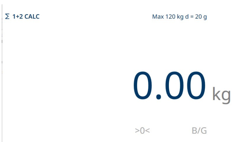
Figura 53: IND700 permette di concentrarsi su una delle tre aree di visualizzazione del peso
