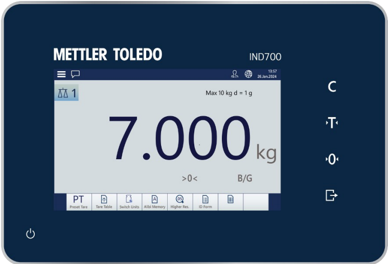
Figura 44: Pannello anteriore del terminale IND700 con bordo e touchscreen al centro
