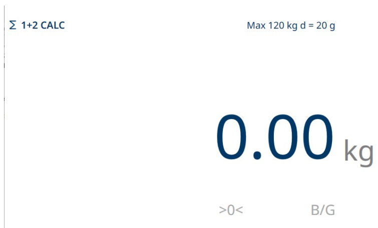
Fig. 53: Terminal IND700 focalisé sur l'une des trois zones d'affichage du poids
