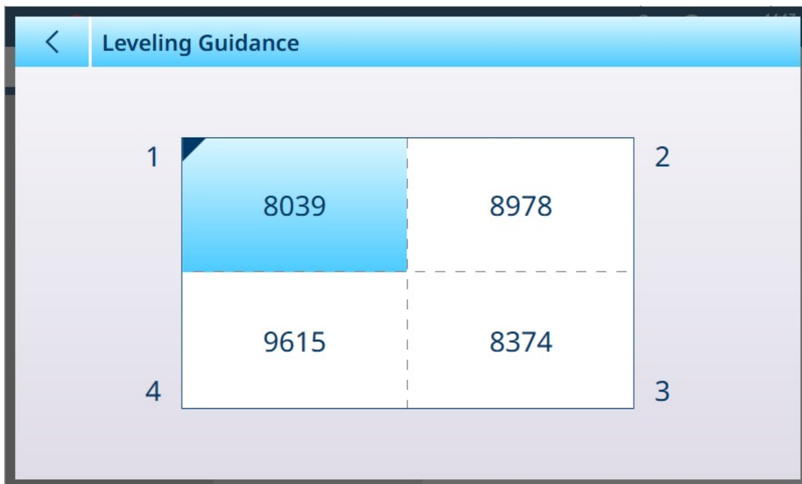
Fig. 536: Guidage de niveau, balance à 4 capteurs de force
