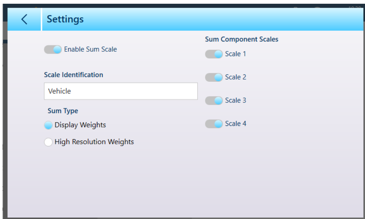
Fig. 201: Réglages de la balance de somme avec plusieurs balances logiques
