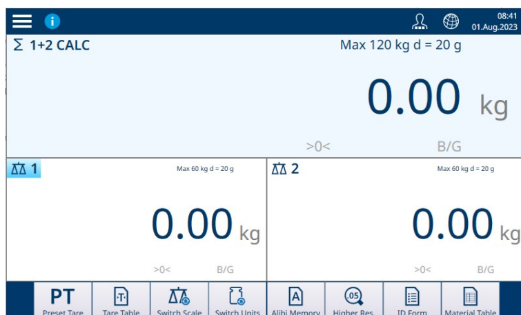
Fig. 52: Terminal IND700 affichant deux balances HSALC et une balance de somme
