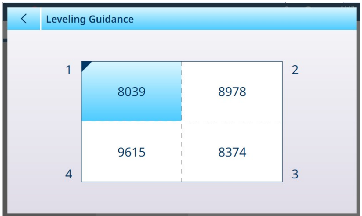
Abb. 536: Nivellierhilfe, Waage mit 4 Wägezellen
