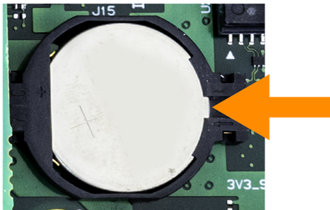
Abb. 535: Entfernen der Batterie
