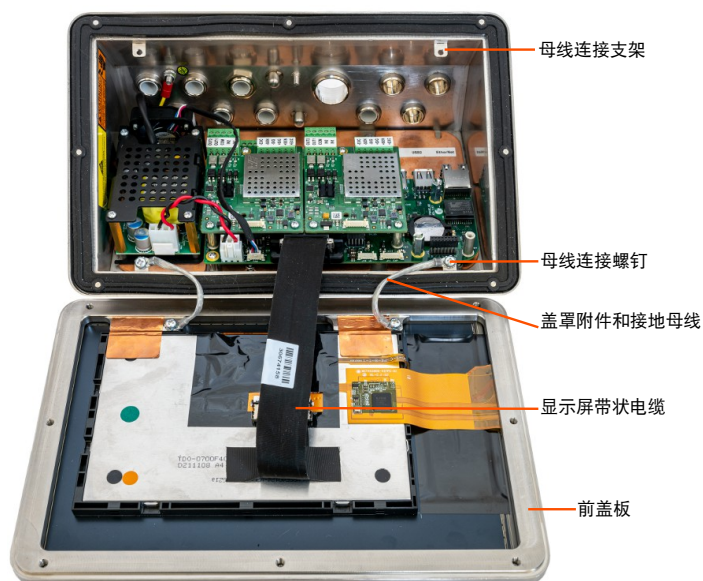
图 30: 按正常方向安装的前盖板
