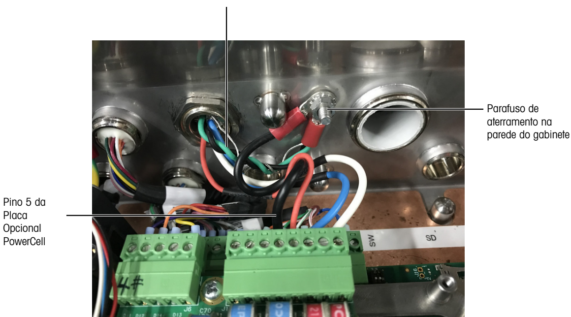
Fio de drenagem interno enrolado em fios terra
