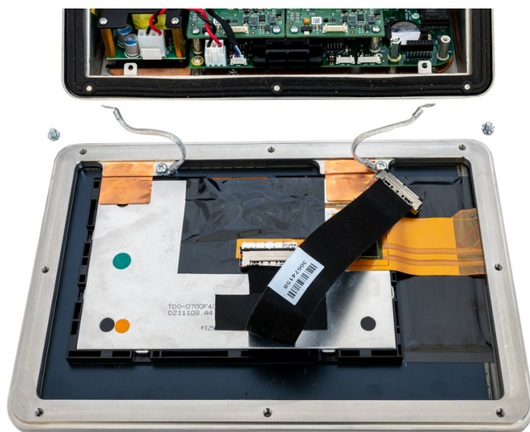
Fig. 31: Cubierta delantera desmontada de la carcasa
