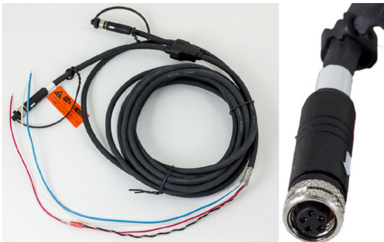
图 51: PowerMount 主电缆（左）和连接器（右）
