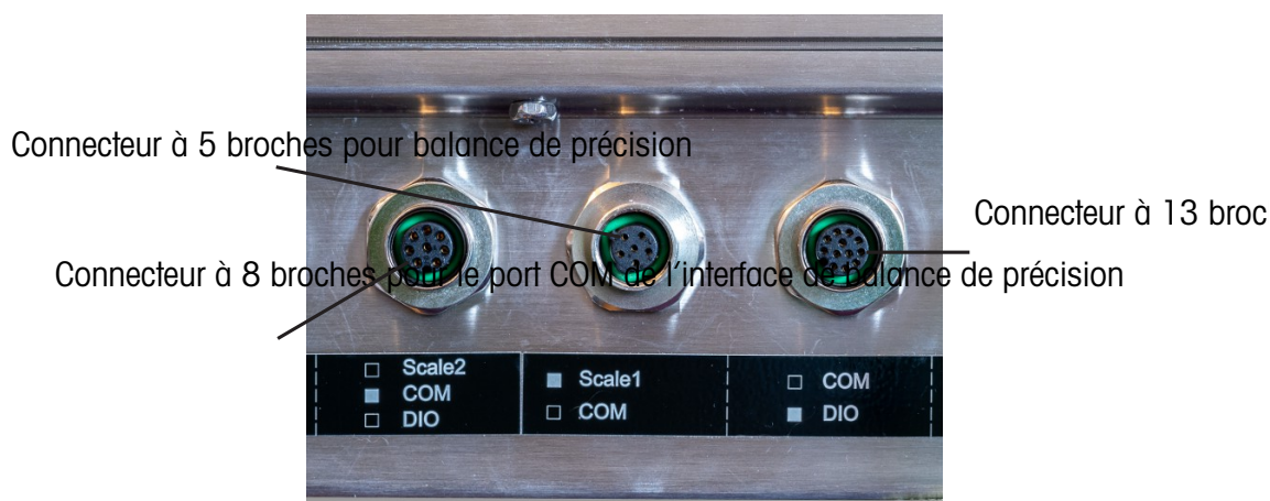
Fig. 57: Connecteurs M12 externes associés à la carte d'interface de précision
