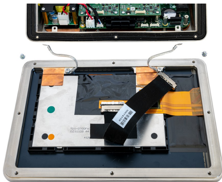
Figura 31: Tampa Frontal Separada do Gabinete
