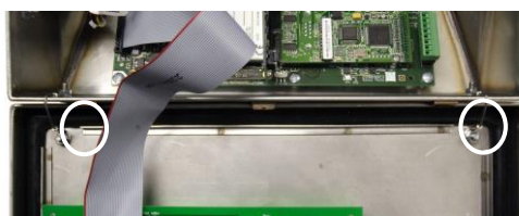
图 4-7: 上下盖接地线位置
