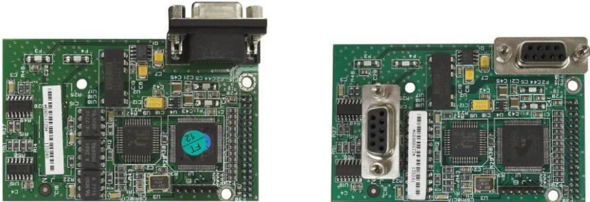
图 4-39: PROFIBUS 防尘式（左）和面板式（右）接口板
