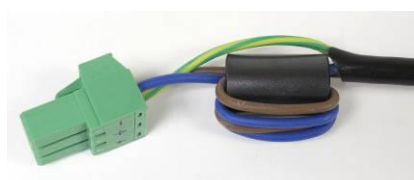
图 4-11: 电源线的磁环安装方法（注意接地线不穿过）
