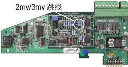
图 4-23: 模拟传感器接口板
