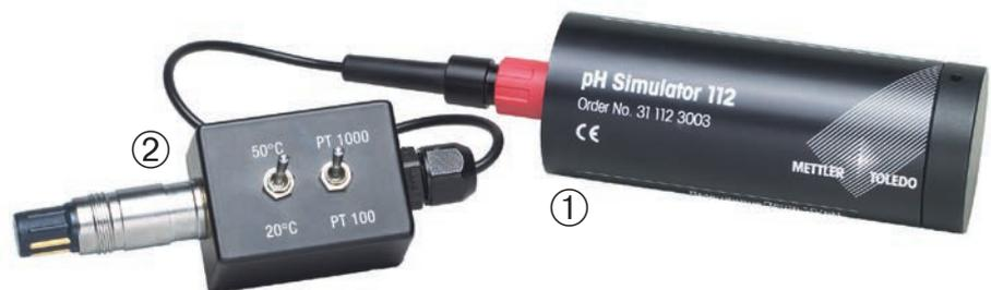
Kits de vérification pH analogique : en combinant le simulateur de pH 112 ① et le simulateur VP ②, vous pouvez simuler les signaux de pH et de température pour vérifier la capacité de compensation automatique de la température du transmetteur.
