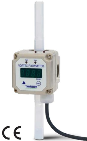
La solution ultime pour mesurer les débits d'eau ultrapure et de produits chimiques. Les sondes de débit Vortex se composent d'un monocorps moulé et sont disponibles en PFA, PVC ou PVDF. Sans pièces mobiles, tous les risques de contamination de liquide sont éliminés grâce à une conception entièrement en plastique pour une résistance à la corrosion.
