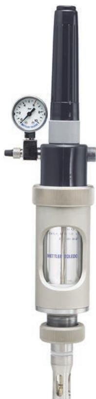
Les supports InFit 764 e sont spécialement conçus pour maximiser les performances et la longévité des électrodes de pH et redox à électrolyte liquide. Le support doit être pressurisé pour maintenir un différentiel de pression positif entre la solution de remplissage de la sonde et le procédé. Ce différentiel positif élimine toute contamination de l'électrode par le franchissement du diaphragme par le produit. Une grande fenêtre de contrôle facilite la surveillance du niveau d'électrolyte.
