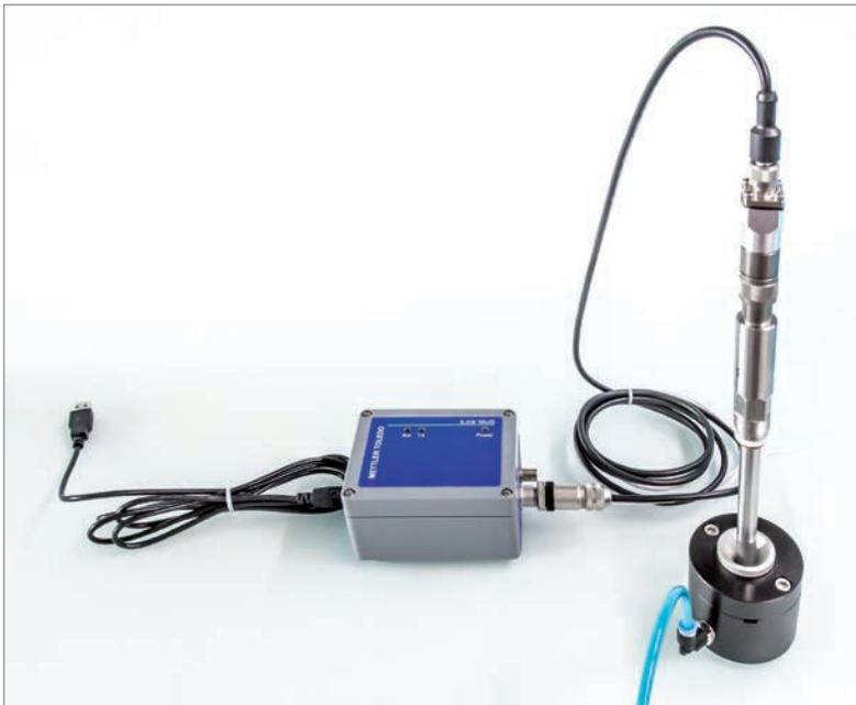
**iLink Multi** est un appareil universel permettant de connecter une sonde ISM numérique (1 fil ; RS 485) sur un PC/ordinateur fonctionnant avec le logiciel ISM Core. Lors de l'étalonnage d'une sonde à oxygène dissous optique avec iLink Multi, les paramètres d'étalonnage sont automatiquement saisis à l'aide des capteurs de paramètres physiques intégrés.
