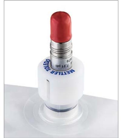
InSUS 310i installé dans un embout soudé
