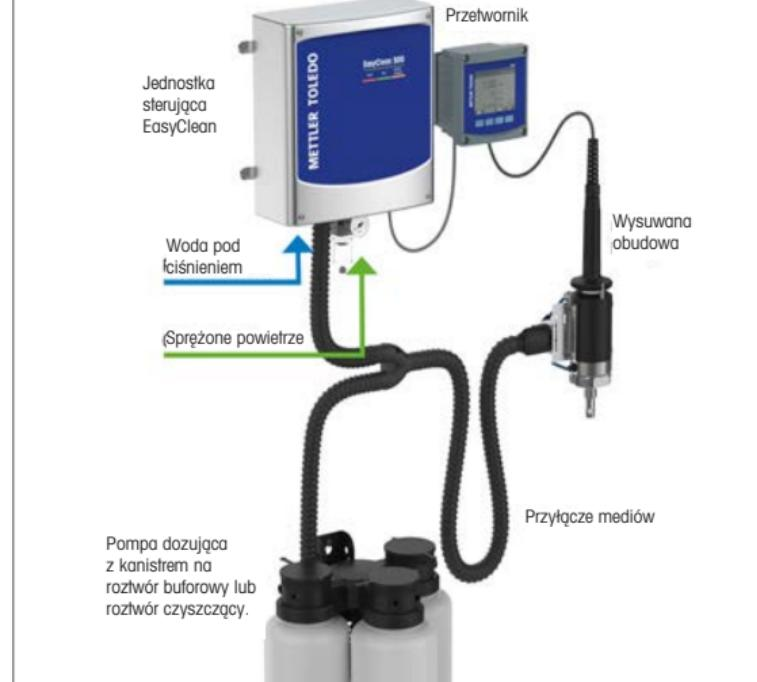
Pompa dozująca z kanistrem na roztwór buforowy lub roztwór czyszczący.
