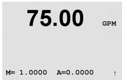
Pressione [ENTER] para exibir todas as constantes de calibragem do sensor. As constantes de calibragem podem ser alteradas nesse menu. Se o tipo de sensor selecionado anteriormente foi Alto ou Baixo, os valores M e A serão exibidos. Se Tipo 2 foi selecionado, será exibida uma tabela de valores K e F.
