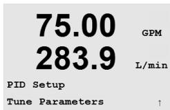
Este menu atribui controle a uma medição e define os parâmetros de ajuste, o ponto de definição e as funções não lineares do controlador.
