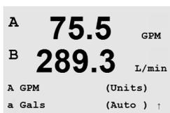
Os transmissores de quatro canais permitem a configuração de valores primários (A, B, C, D) e secundários (a, b, c, d). Pressione [ENTER] para exibir os canais B a D.
