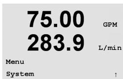
測定モード中に ◀ キーを押します。▲ または ▼ キーを押して、[System – Menu] に進みます。必要な場合は、システム セキュリティ コードを入力します (9.3 章を参照)。[ENTER] を押します。
