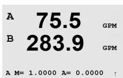
Type 2 センサの場合、マルチプライヤ「M」の後に K 値と F 値が入力されます。[ENTER] キーを押すと、追加の K 係数と F 係数が表示されます。[ENTER] をもう一度押して続行します。
