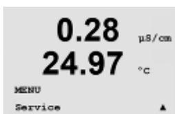
測定モード中に ◀ キーを押します。▲ または ▼ キーを押して [Service] に進み、[ENTER] を押します。必要に応じてセキュリティ コード「xxxxx」を入力し (9.3 章を参照)、[ENTER] 押してコードを確認します。次に使用できるシステム設定のオプションを説明します。
