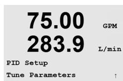
このメニューでは、測定にコントロールを割り当てます。また、補正パラメータ、セットポイント、コントローラの非線形機能を設定します。
