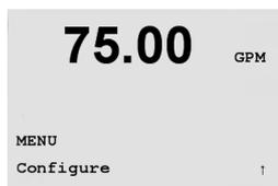
測定モード中に ◀ キーを押します。▲ または ▼ キーを押して、[Configure – Menu] に進みます。[Configure – Menu] を選択し、必要な場合は、セキュリティ コード「xxxxx」を入力します (9.4 章を参照)。**[ENTER]** キーを押して、コードを確認します。
