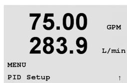
測定モード中に ◀ キーを押します。▲ または ▼ キーを押して、[PID Setup] メニューに進み、[ENTER] を押します。必要に応じてシステムのセキュリティコード「xxxxx」を入力し (9.3 章を参照)、[ENTER] キーを押してコードを確認します。
