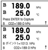
サンプルを取得し、[ENTER] キーをもう一度押して、現在の測定値を保存します。校正中の場合、チャンネルに応じて A または B がディスプレイで点滅します。
