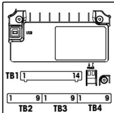
**Hinweis:** Dieses Gerät verfügt über 4-Leiter-Anschluss mit spannungs-führendem Analog-ausgang 4–20 mA.
