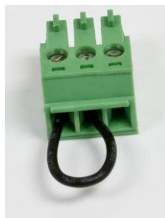
Figura 5-6: Jumper entre os terminais COM1 de transmissão e recepção
