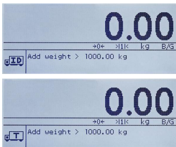
Figura 2-15: Schermate di applicazione della pesa del veicolo: ID permanenti (in alto) e ID temporanei (in basso)
