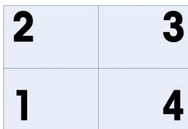
Figura 3-7: Sequenza di indirizzamento di 4 PowerDeck a quattro celle
