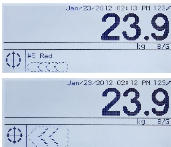
Figura 4-8: Display grafico SmartTrac, zone non attivate: piccolo (in alto) e grande (in basso)
