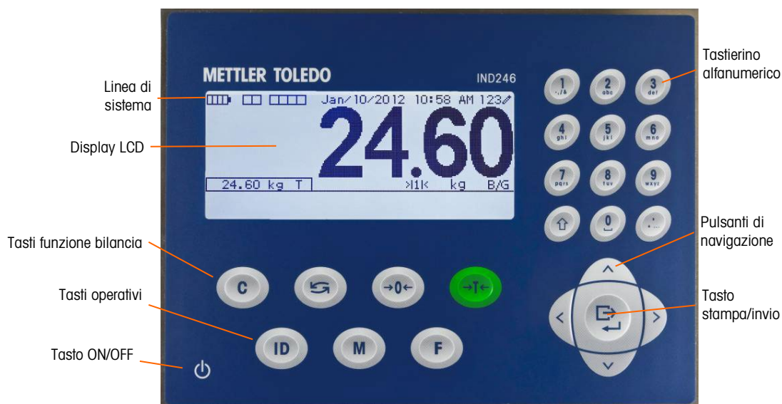
Figura 1-5: Layout del pannello anteriore di IND246
