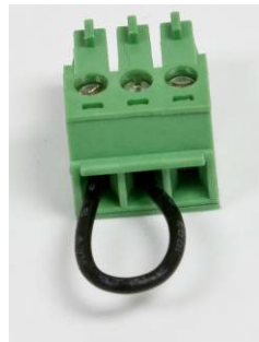
Abbildung 5-6: Drahtbrücke zwischen COM1-Sende- und Empfangsklemmen
