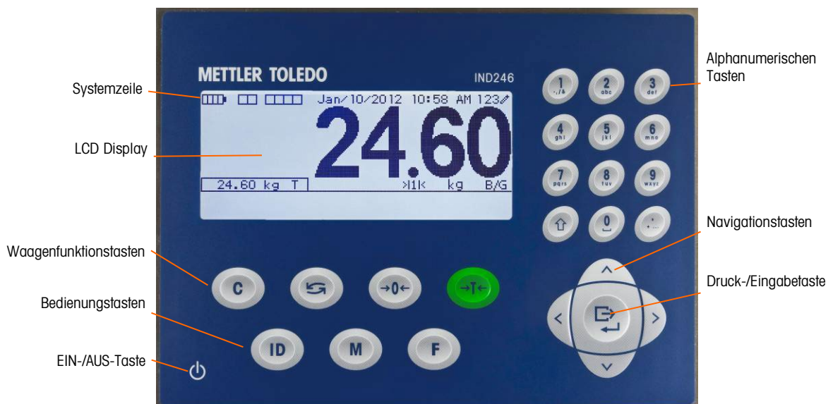
Abbildung 1-5: Layout des IND246-Vorderfeldes
