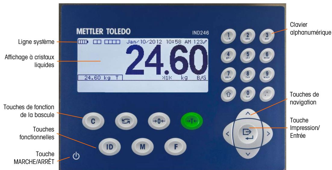
Figure 1-5 : Agencement du panneau avant de l'IND246
